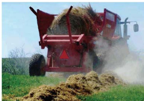
Укладка переработанного материала в валки
