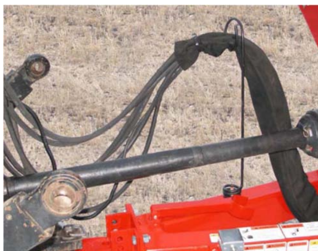
Шланги и кабель, проведенные через кронштейн
