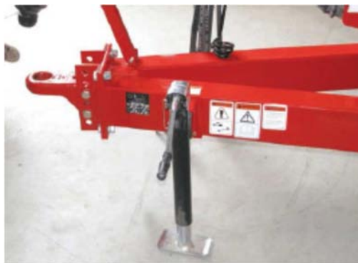
Домкрат установлен на прицепном устройстве
