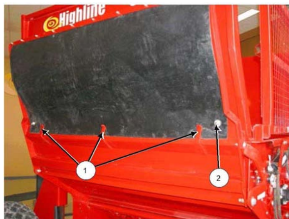
Снятие креплений резиновой панели
