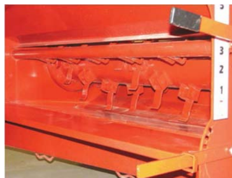
Проверка состояния цепов
