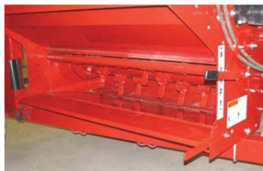
Устранение мусора в области цепового барабана
