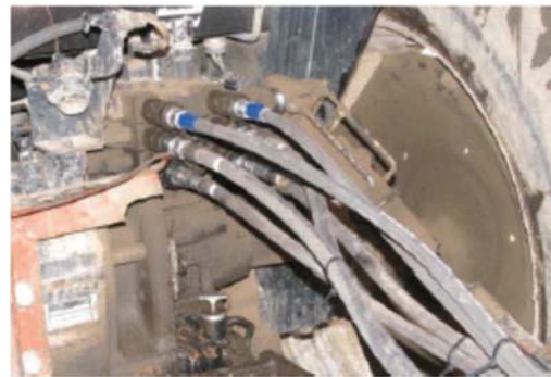
Отсоединение гидравлических шлангов и электрических проводов
