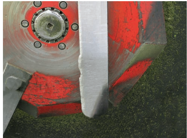
Replace Blade When Gouged
