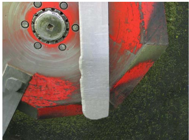
Replace Blade When Gouged 107080
