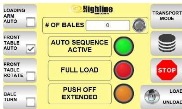
Front Table Auto - No Table Rotate
