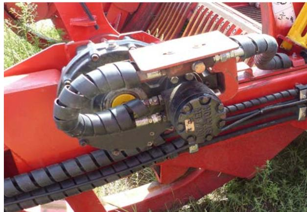
Graissez les roulements du rabatteur et remplacez l'huile de la boîte d'engrenages 22231
