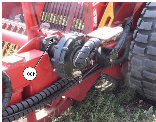
Graissez le roulement du rotor
