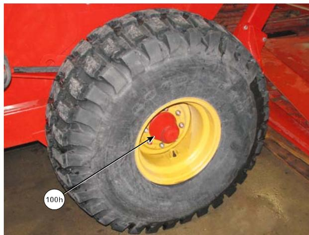
Graissez les moyeux des roues
