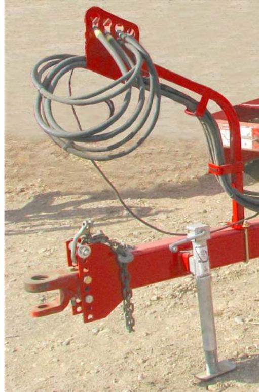
Débranchez la chaîne de sécurité et la flèche (Plaque de réglage de la barre d'attelage à chape illustrée) 216233-2
