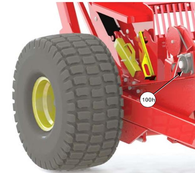
Graissez le roulement du rotor
