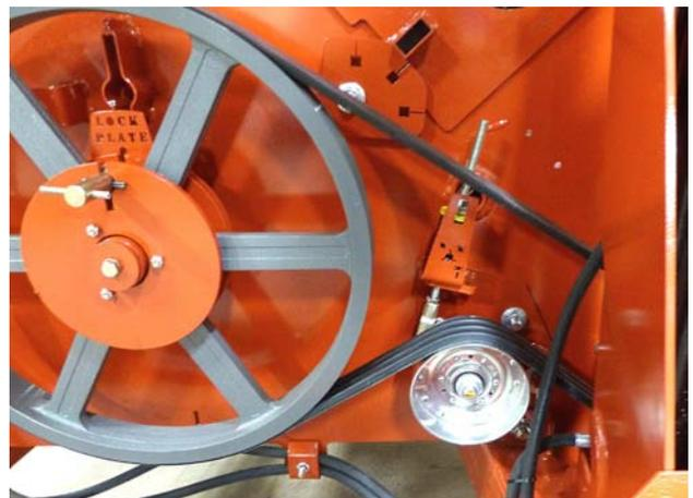
Проверка натяжения приводного ножа кормоизмельчителя
