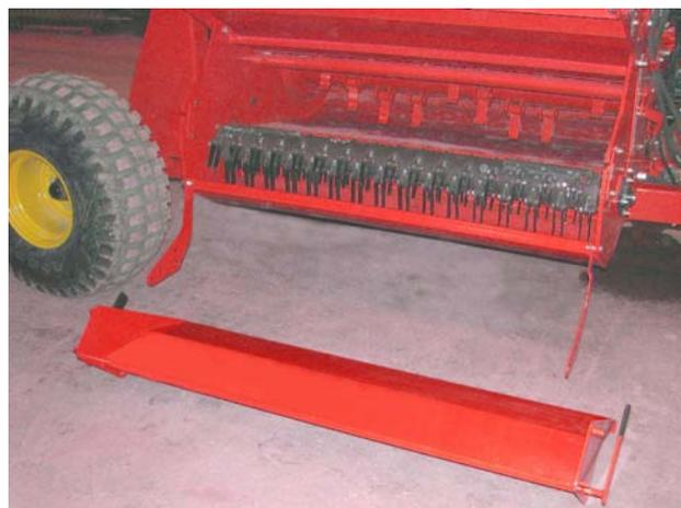
Снимите разгрузочную дверцу 201237
