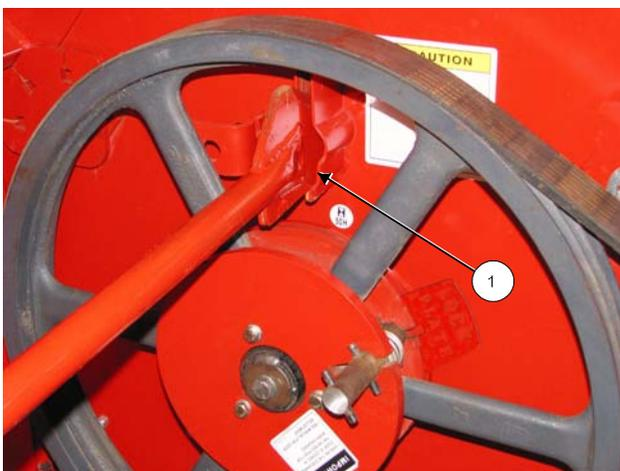
Доступ к механизму для разрезания шпагата 201261C
