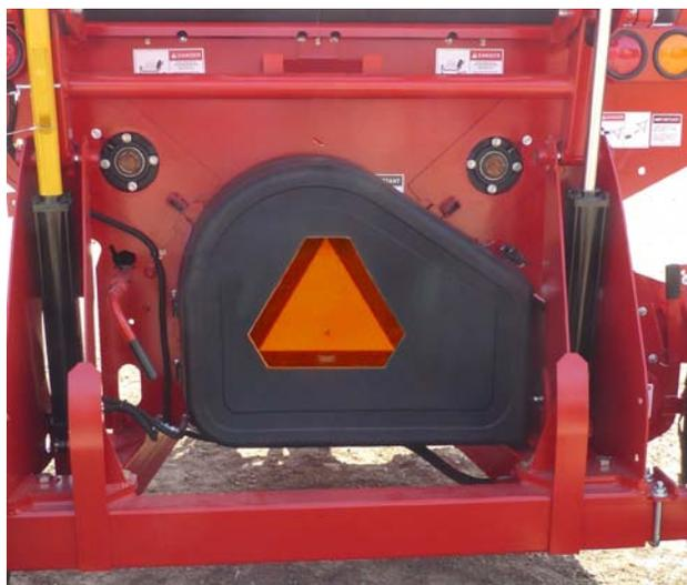
Откройте дверцу защитного кожуха привода
