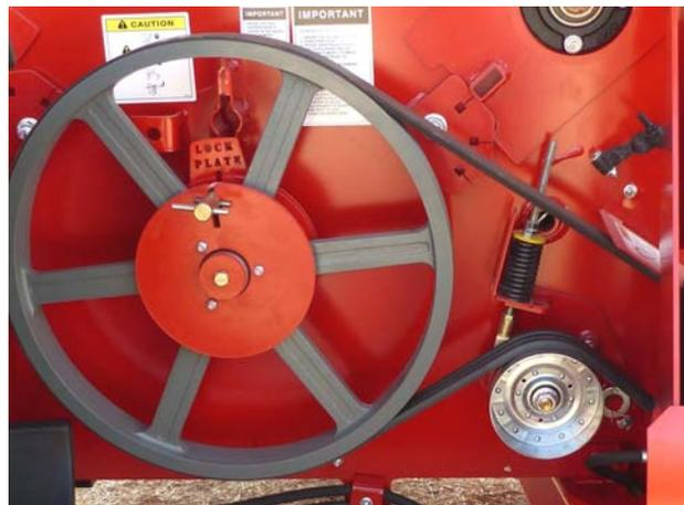
Проверка натяжения приводного ножа кормоизмельчителя
