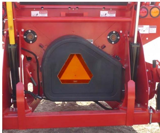
Закройте и закрепите защитную дверцу кожуха привода
