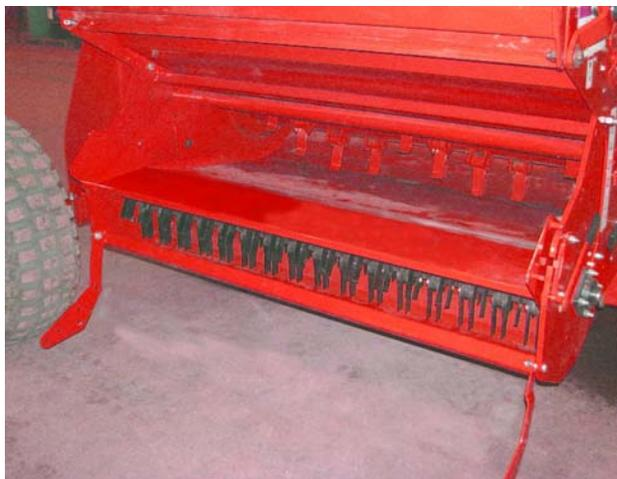
Отсоединение держателя разгрузочной двери<sub>201238</sub>
