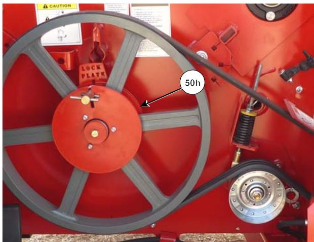
Смазывание подшипника цепного барабана 221366C
