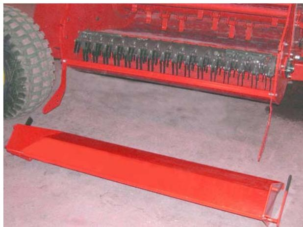
Снимите разгрузочную дверцу<sub>201237</sub>
