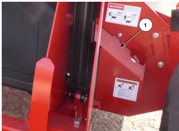
Снятие защитного кожуха
