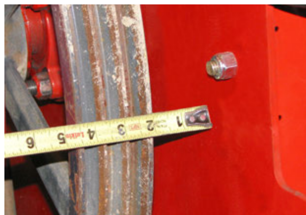
Измерьте расстояние - между большим шкивом и стенкой бункера
