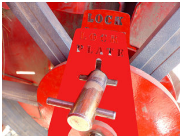
Отсоедините привод измельчителя
