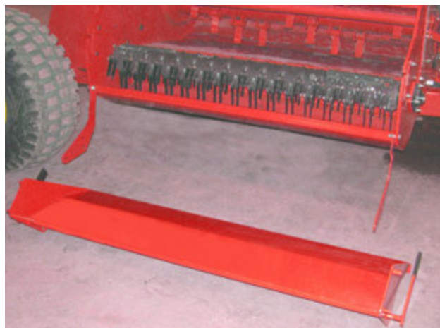
Снимите разгрузочную дверцу 201237
