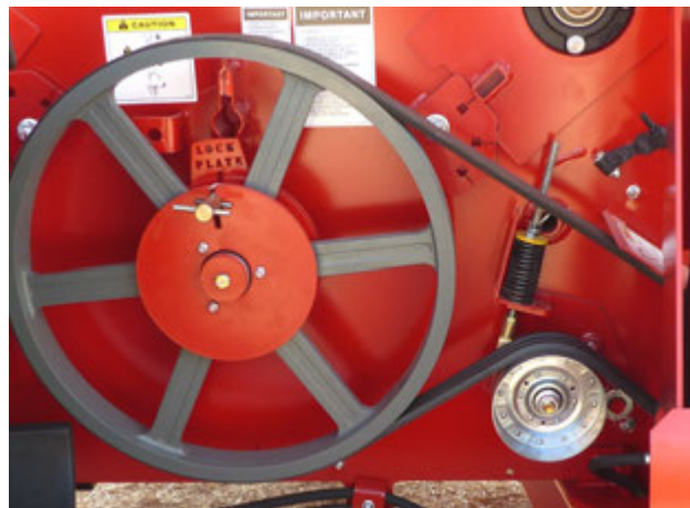
Проверка натяжения приводного ножа кормоизмельчителя
