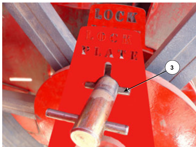
Оттяните штифт муфты и проверните его для фиксации
