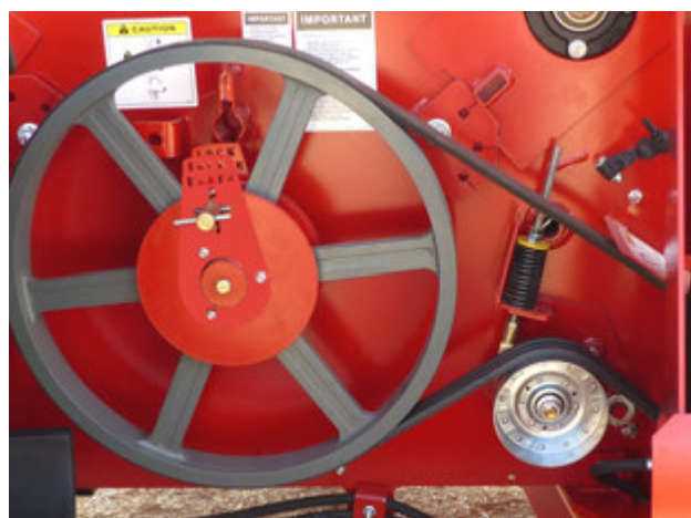
Установка нового ремня на место
