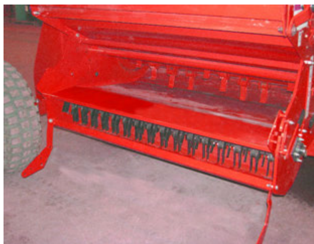
Отсоединение держателя разгрузочной двери 201238
