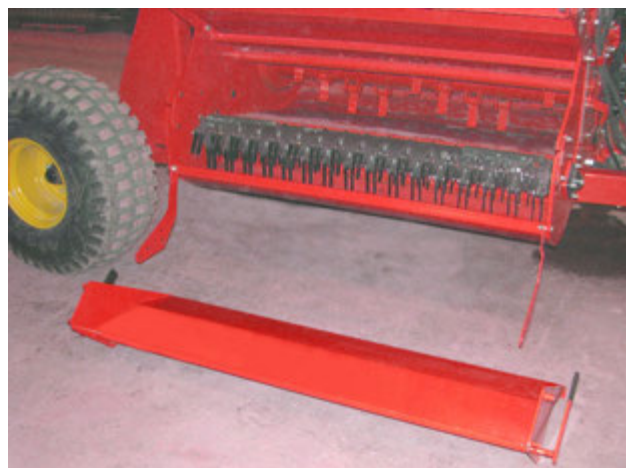
Снимите разгрузочную дверцу 201237
