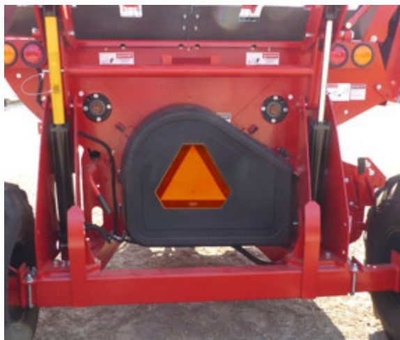
Защитный кожух привода установлен на месте
