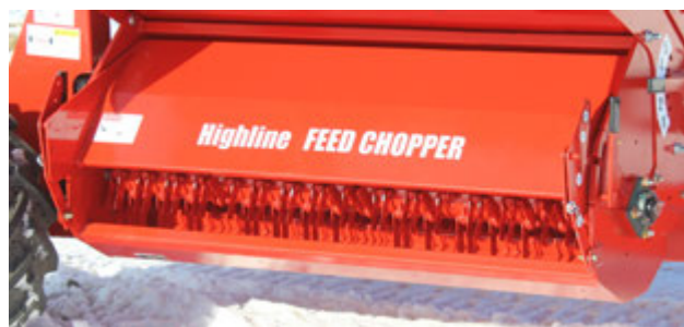
Проверка состояния ножей
