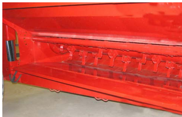
Проверка и очистка области цепного барабана
