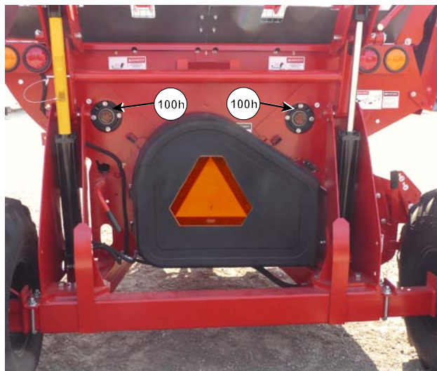
Смазывание заднего подшипника подающего вала 221360C
