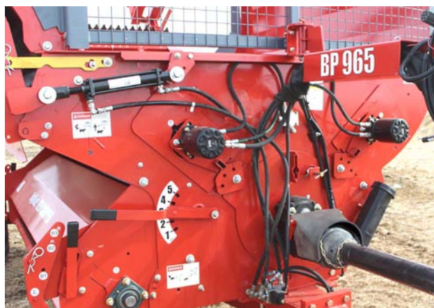
Проверка гидравлической системы
