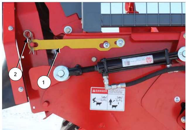
Установка фиксирующего замка двери дефлектора
