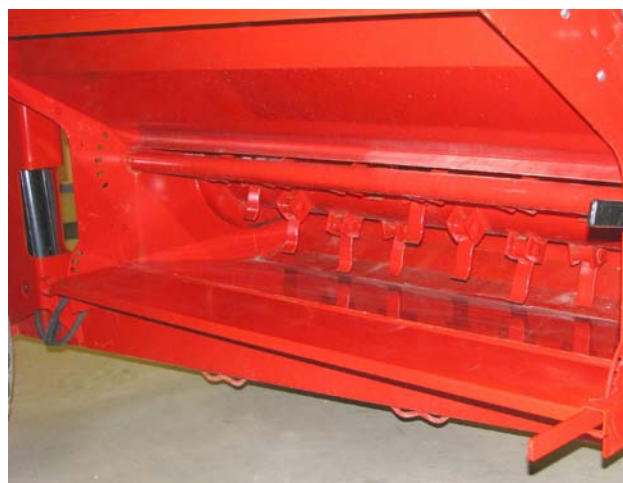
Проверка и очистка области цепного барабана
