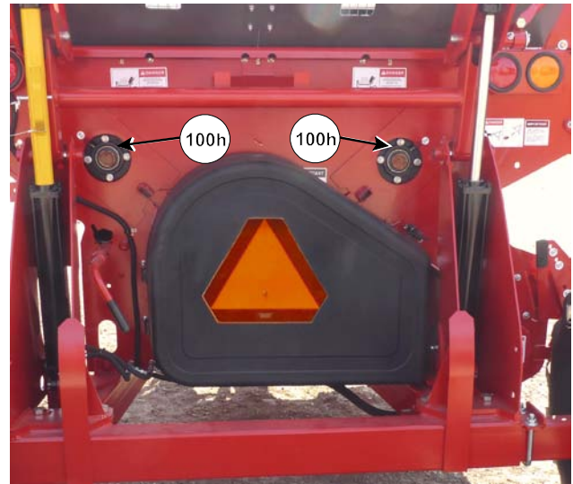
Смазывание заднего подшипника подающего вала
