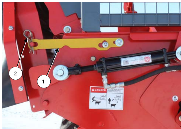
Установка фиксирующего замка двери дефлектора
