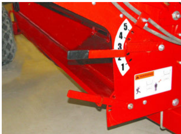
Измените положение рычага регулирования нормы выгрузки (при необходимости)
