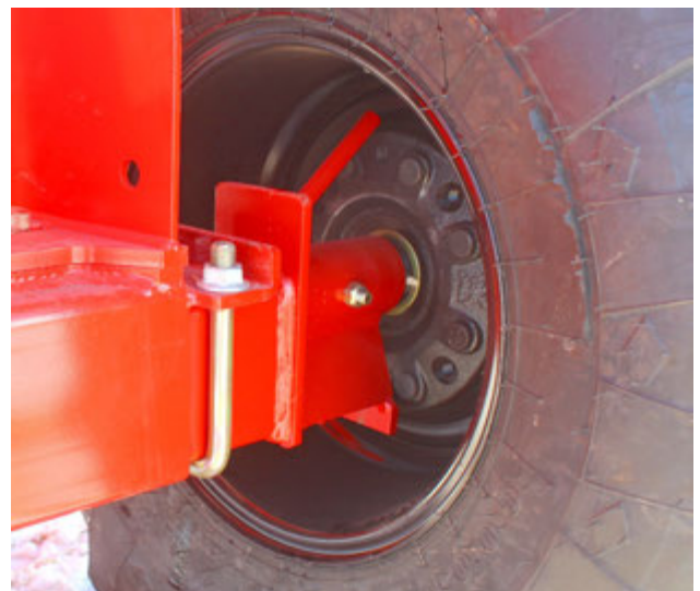
Извлеките остатки шпагата со шпинделя и ступицы
