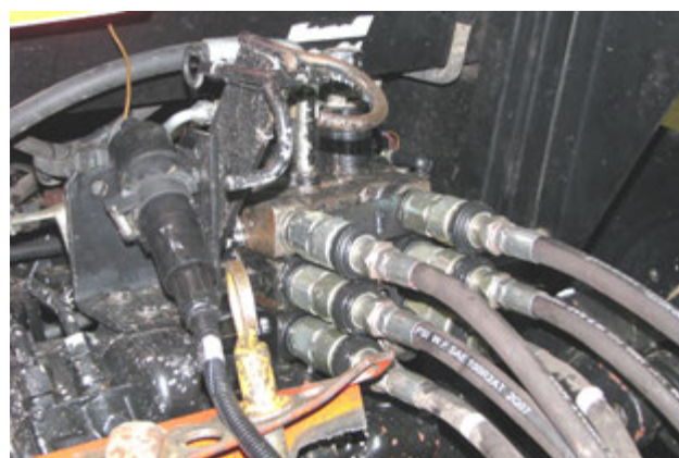
Отсоединение гидравлических шлангов и электрических проводов
