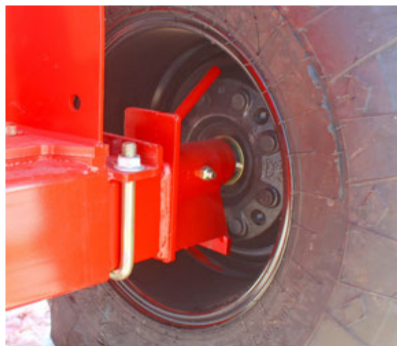
Извлеките остатки шпагата со шпинделя и ступицы
