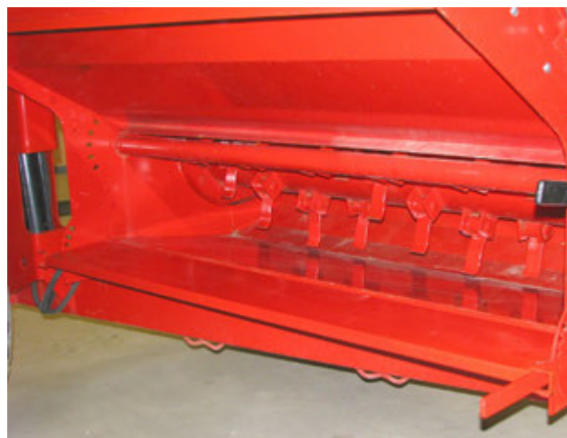
Проверка и очистка области цепного барабана
