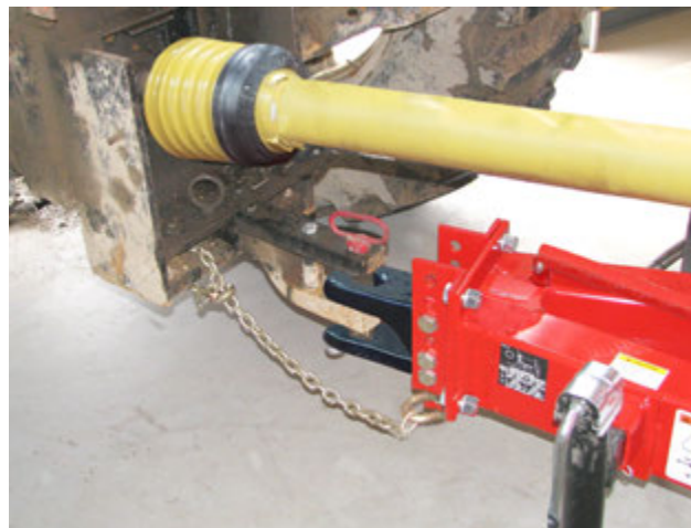
Регулировка высоты прицепного устройства 224138
