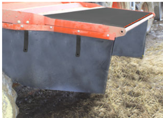
Резиновая завесаверху двери для производства подстилки 223205
