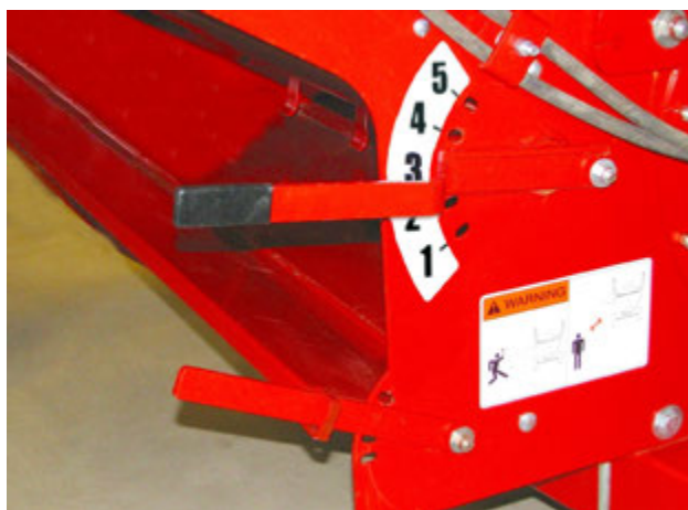
Настройка уровня агрессивности цепов
