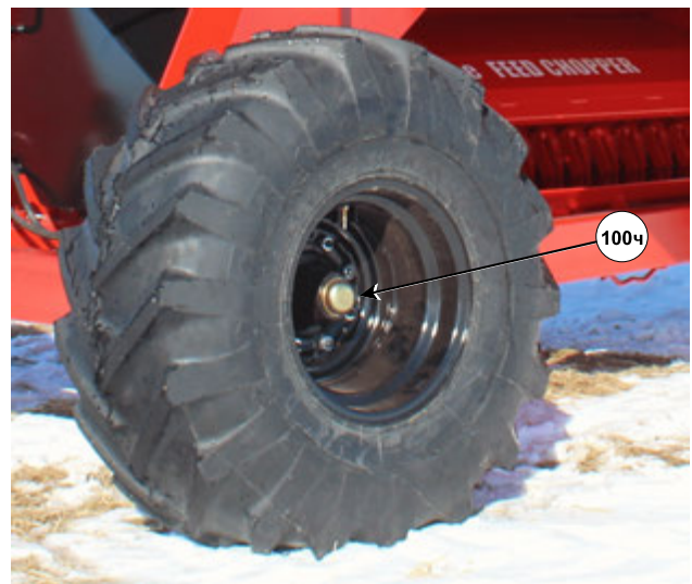
Смазывание ступиц на шпинделях
