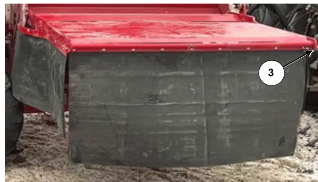
Резиновая завеса опущена вниз, соедините фиксаторы завесы для раздачи корма
