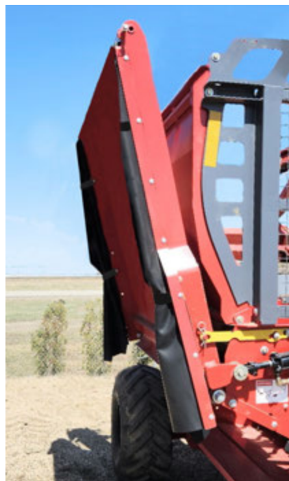
Боковые шторки свернуты и зафиксированы 223202
