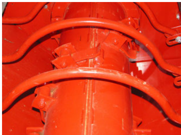
Перемещение цепов, блокирующих паз ножа. 201230
