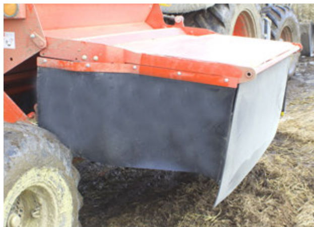
Настройка положения верхней разгрузочной двери (изображена подача материала в валок)
