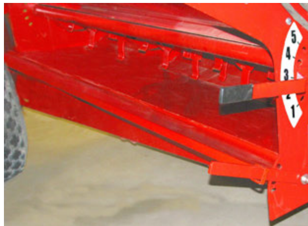
Установка положения нижней разгрузочной двери 214084-2
