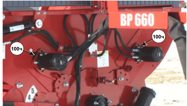
Смазывание переднего подшипника подающего вала (Защитный щиток мотора не показан для наглядности)
