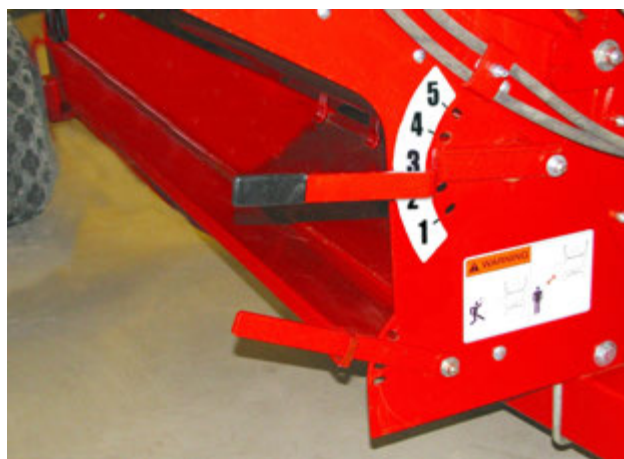
Настройка нижней разгрузочной дверцы
