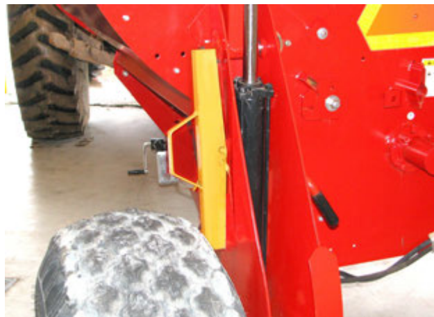
Снятие замка цепного барабана и установка его в место для хранения
