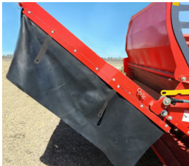
Боковые шторки в положении для формирования подстилки или валков. 223201
