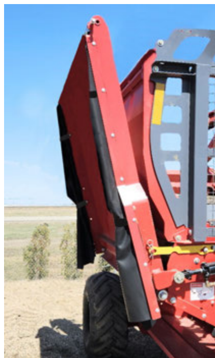
Боковые шторки свернуты и закреплены. 223202
