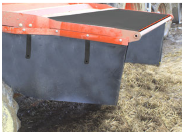
Резиновая завеса на верхней части двери для разброса подстилки
