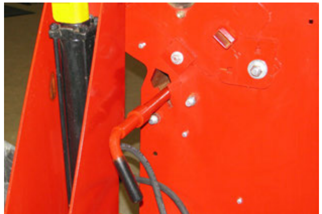
Установите нож для шпата в место для хранения
