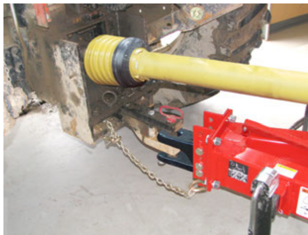
Отсоедините привод и страховочную цепь
