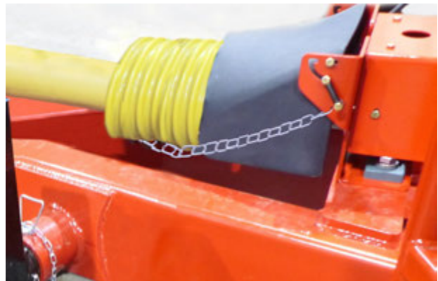
Подсоедините цепи кожуха привода
