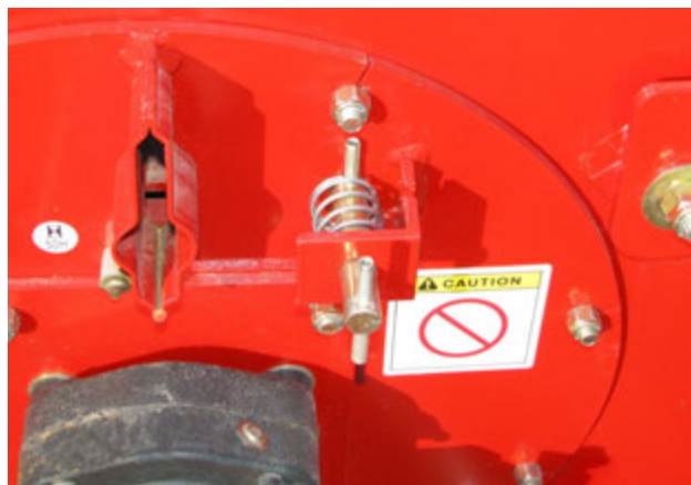
Установка замка цепного барабана в рабочее положение 221364
