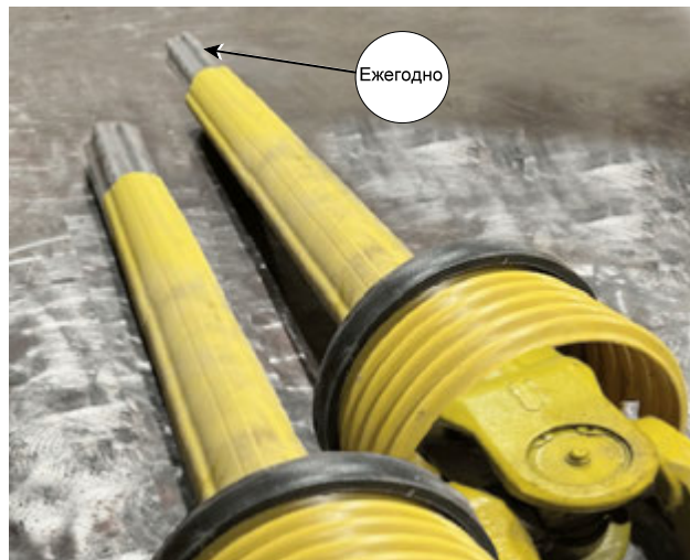
Смажьте скользящий участок приводного вала
