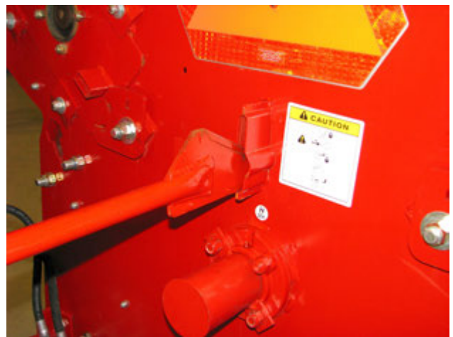
Вставьте нож для шпата / сетки лезвием вверх
