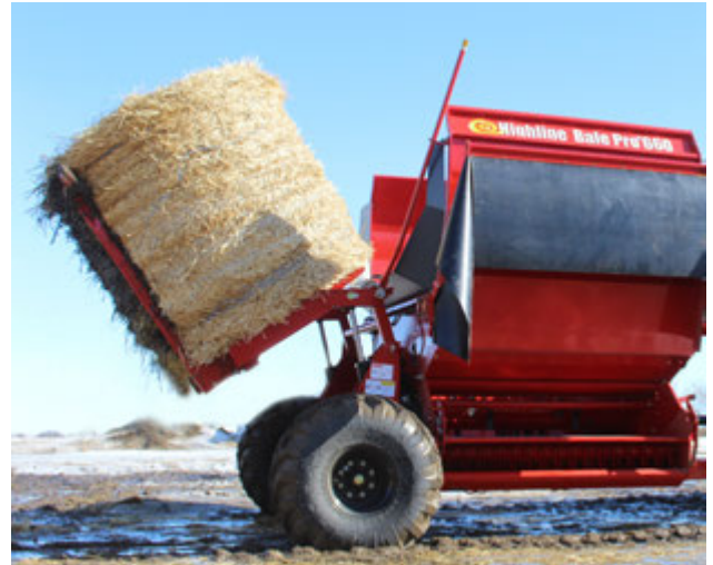
Поднятие тюка в перерабатывающую камеру. 221283
