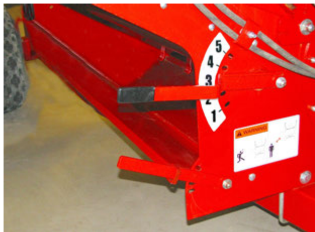
Перемещение рычага ограничительных дуг (не доходя до позиции №5) 214087-2
