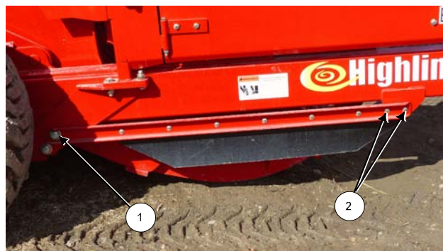
Fixez le bouclier de protection du tambour inférieur droit
