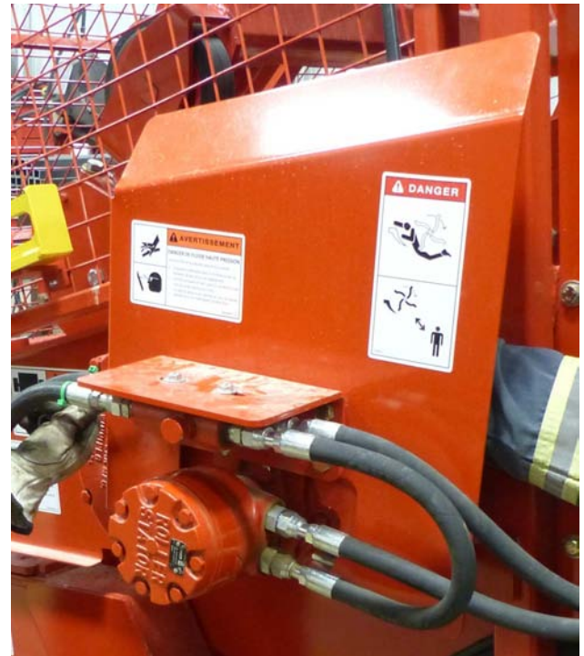
Installation de la protection de la boîte d'engrenages
