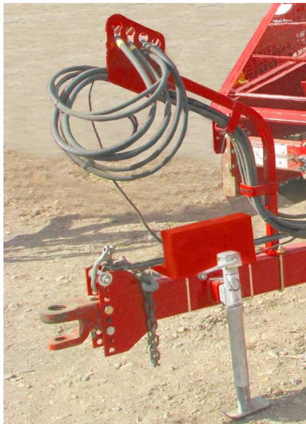
Acheminement des tuyaux flexibles dans le support d'attelage 220040
