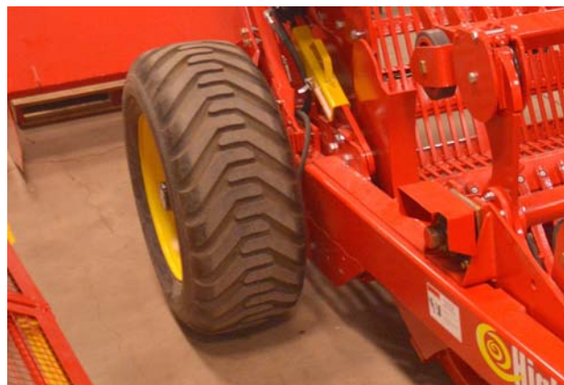
Installez la roue (remarque : roue droite illustrée - direction de la bande de roulement la même)
