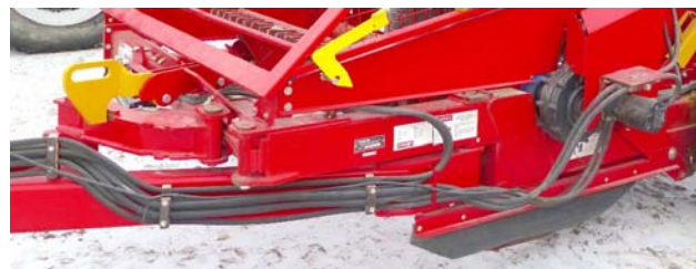
Acheminement des tuyaux flexibles hydrauliques à travers les colliers de serrage
