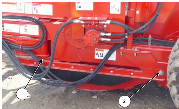
Fixez le bouclier de protection du tambour inférieur gauche
