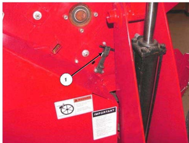
Снимите резиновый запор дверцы
