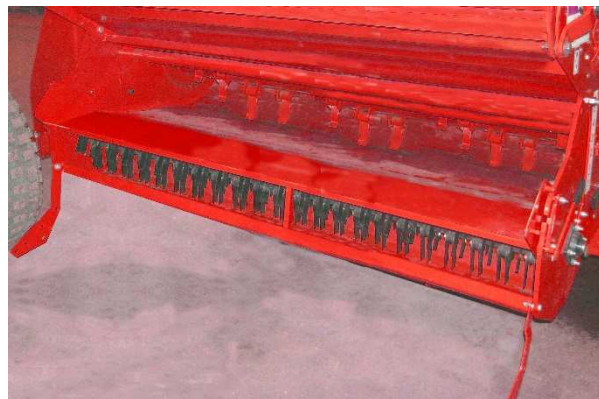
Отсоедините держатели разгрузочной дверцы 215136
