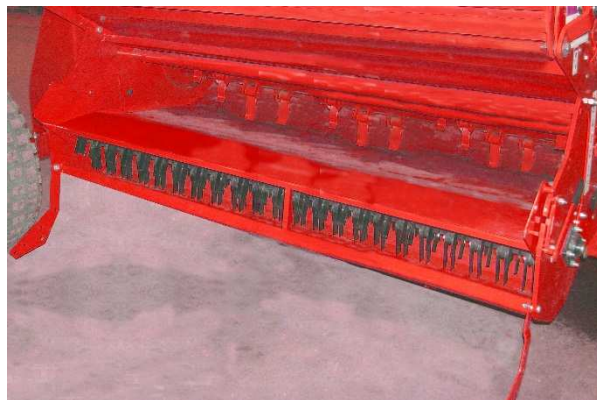
Отсоедините держатели разгрузочной дверцы
