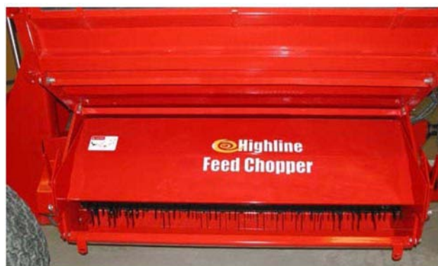
Проверьте состояние ножей
