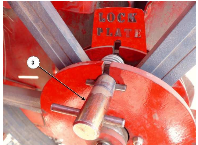
Штырь привода в свободном положении
