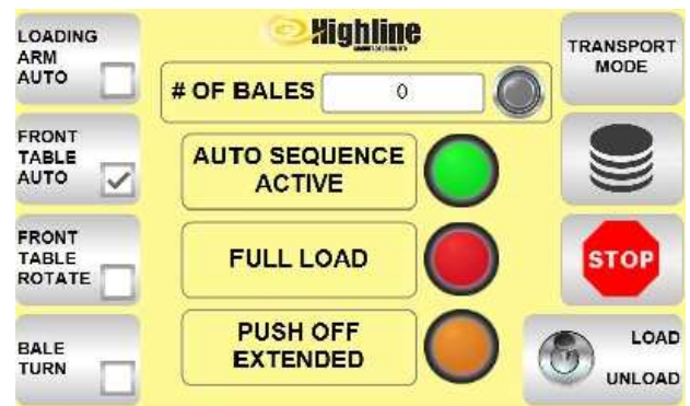
Front Table Auto - No Table Rotate
