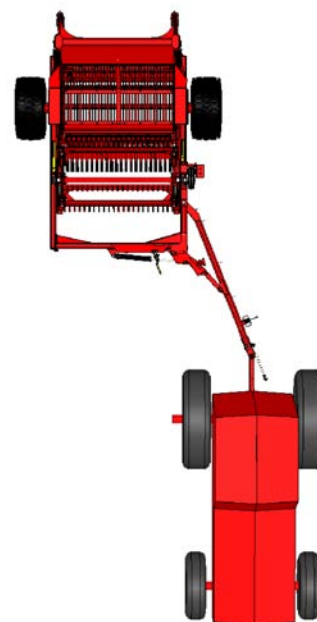
Position 2 de l'attelage : tracteur avec roues simples
