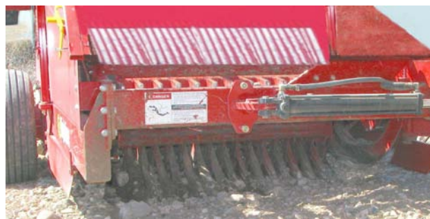
Inversez le sens du rabatteur et relevez le tablier pour retirer les pierres
