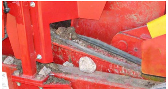
Retirez les pierres sur le châssis
