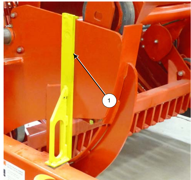
Engagez le verrou du tablier du côté droit
