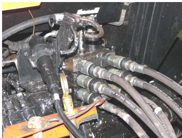
Effectuez les raccordements hydrauliques et électriques
