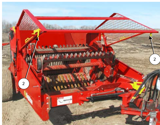
Déverrouillez et soulevez la cage du rabatteur 220030C
