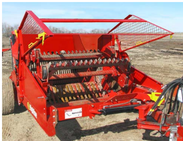
Déverrouillez et soulevez la cage du rabatteur 220030
