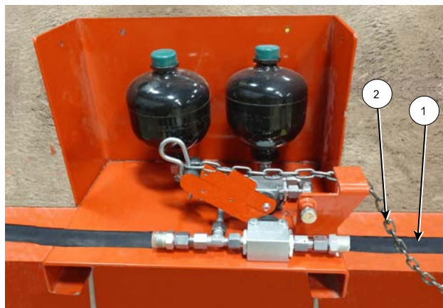
Débranchez le système de rupture du tracteur (Protection enlevée pour plus de clarté)
