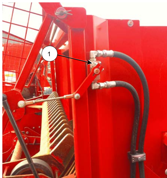
Vanne de verrouillage hydraulique du rabatteur 220029C
