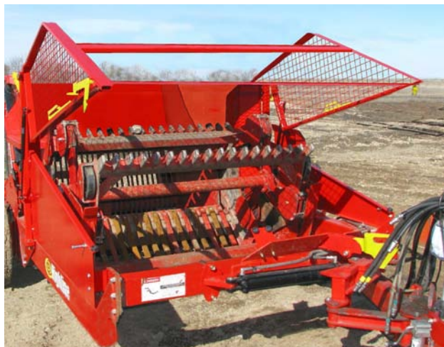
Déverrouillez et soulevez la cage du rabatteur
