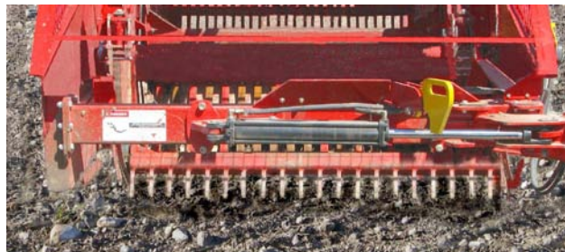
Ajustez la hauteur du tablier
