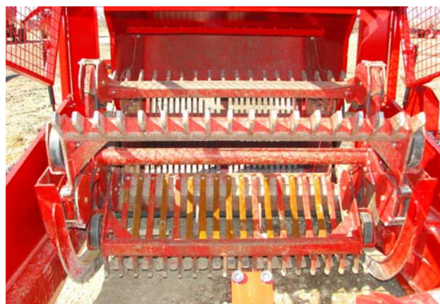
Vérifiez l'état du rabatteur, du tablier et de la trémie
