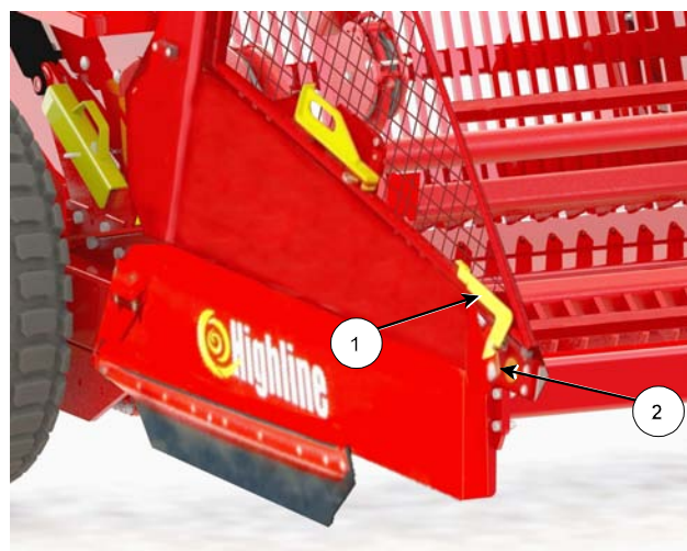
Refermez le panneau, abaissez et verrouillez la cage du rabatteur 220036C
