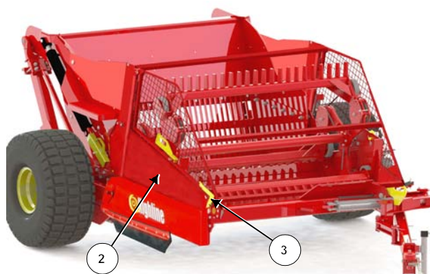
Abaissez et verrouillez la cage du rabatteur
