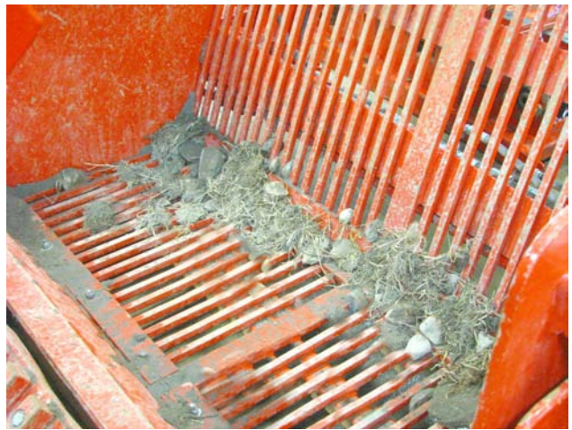
Nettoyez les débris de la trémie
