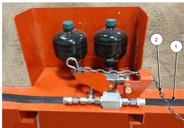
Branchez la chaîne du système de rupture au tracteur (Protection enlevée pour plus de clarté)
