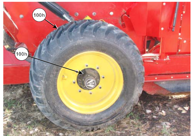
Graissez les moyeux des roues 214026C
