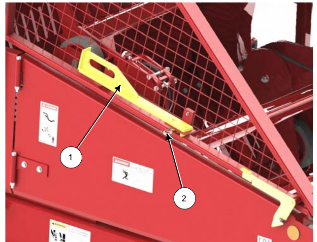
Verrou de transport en position de rangement - côté droit 220035C
