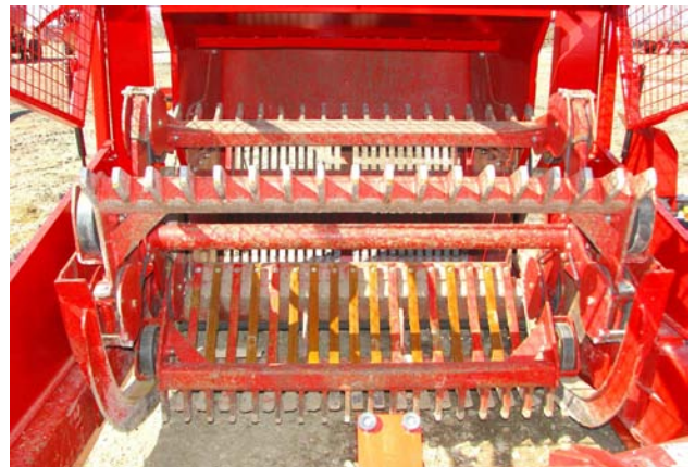
Vérifiez l'état du rabatteur, du tablier et de la trémie
