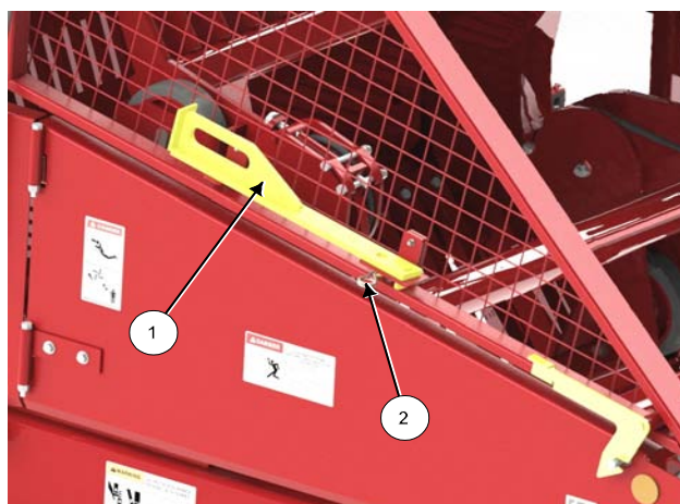
Verrou de transport en position de rangement - côté droit 220035C
