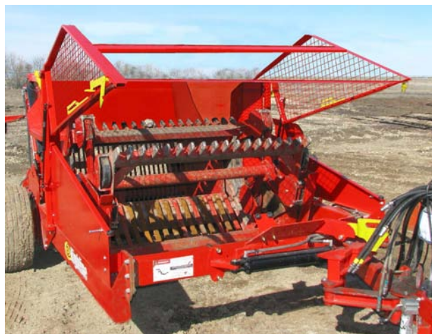
Déverrouillez et soulevez la cage du rabatteur 220030
