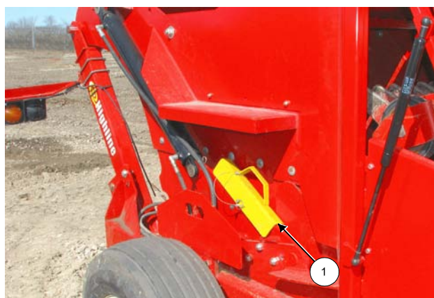
Verrou de la trémie en position de rangement 216093C
