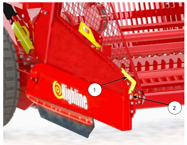
Refermez le panneau, abaissez et verrouillez la cage du rabatteur 220036C
