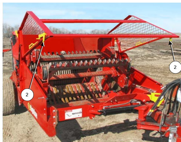
Déverrouillez et soulevez la cage du rabatteur 216080C
