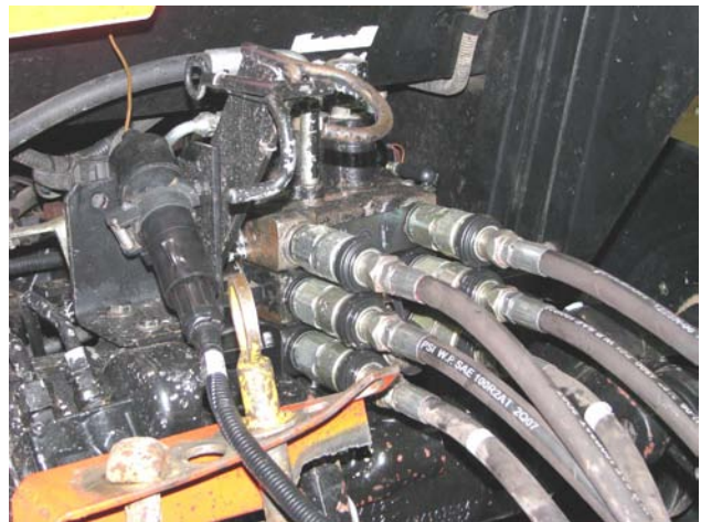
Débranchez les tuyaux hydrauliques
