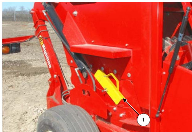
Verrou de la trémie en position de rangement 216093C
