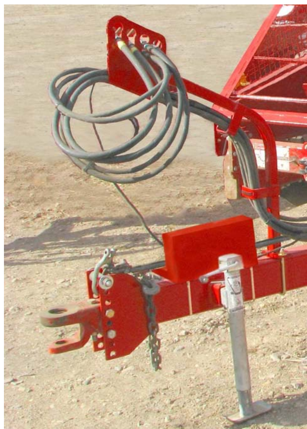
Débranchez la chaîne de sûreté et dételez le timon
