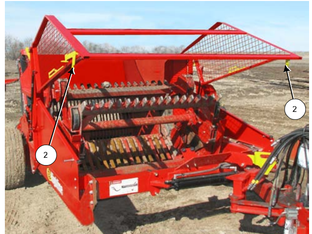
Déverrouillez et soulevez la cage du rabatteur 220030C
