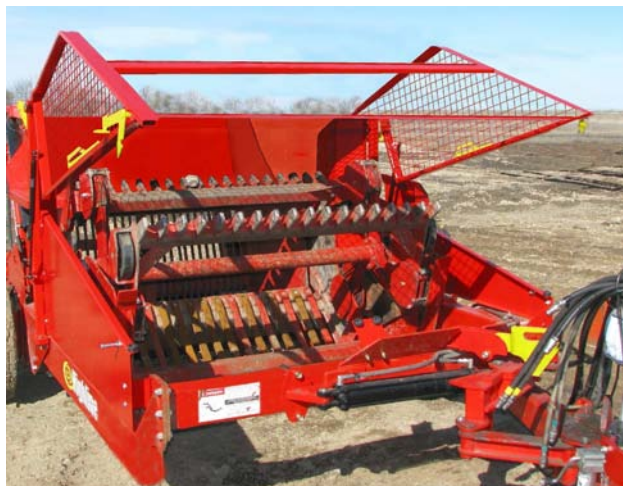
Déverrouillez et soulevez la cage du rabatteur
