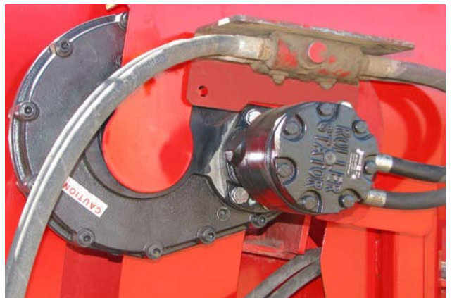
Sostituzione dell'olio della scatola del cambio
