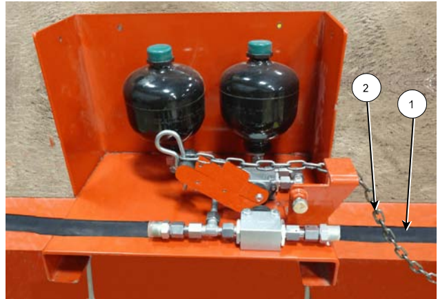
Scollegare il sezionatore dal trattore (Protezione rimossa per maggiore visibilità)
