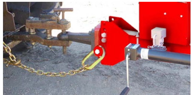
Collegare al trattore. Martinetto in posizione di chiusura.
