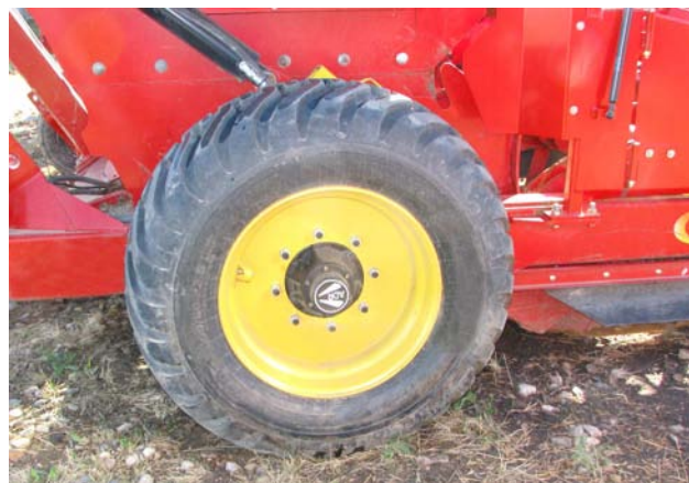
Controllare le condizioni degli pneumatici
