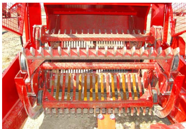
Controllare le condizioni di aspo, rampa di raccolta e cassone 216081
