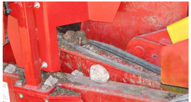
Rimuovere i sassi dal telaio
