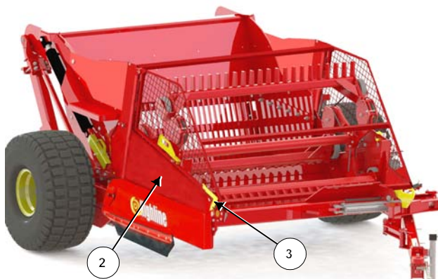
Abbassare e bloccare la gabbia dell'aspo
