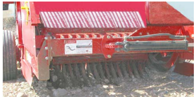
Aspo indietro e sollevamento della rampa per rimuovere i sassi
