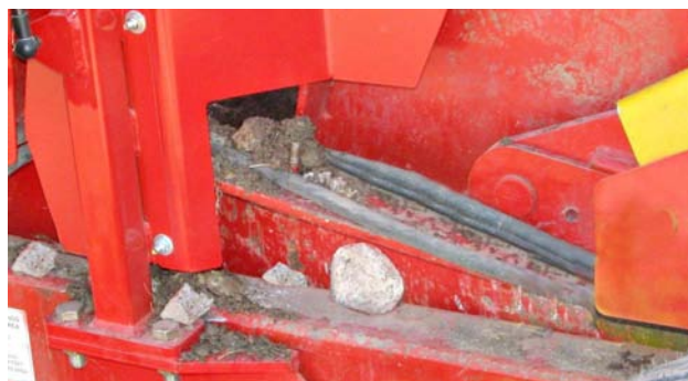
Rimuovere i sassi dal telaio - Lato sinistro
