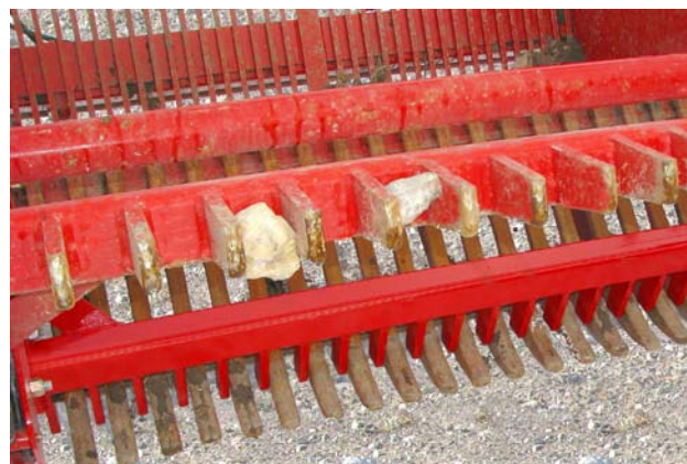
Rimuovere i sassi dai denti della pala 214021
