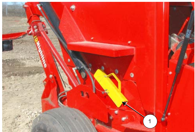
Blocco cassone in posizione di stoccaggio
