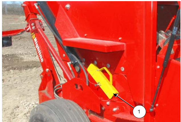
Blocco cassone in posizione di stoccaggio
