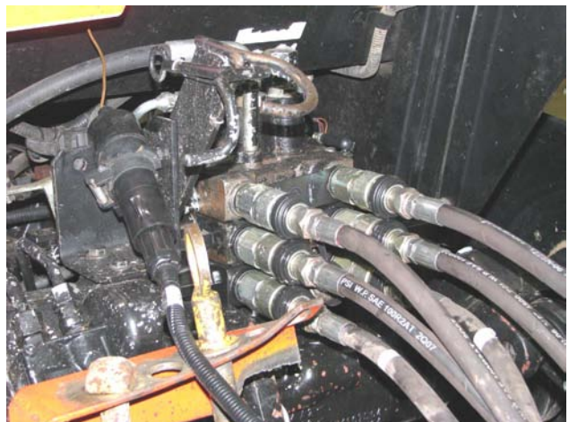
Scollegare l'impianto idraulico
