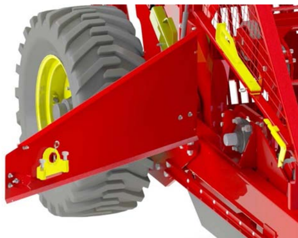
Rimuovere i sassi dal telaio - Lato destro
