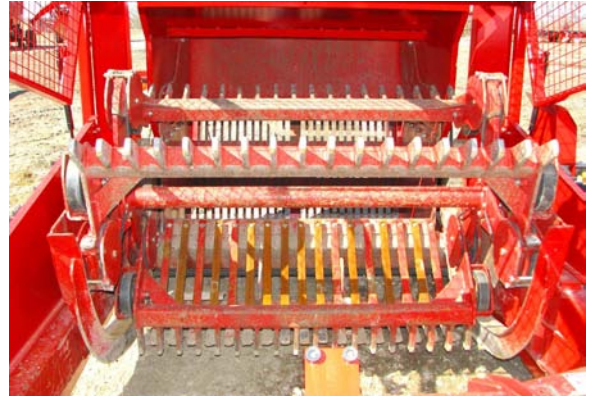
Controllare le condizioni di aspo, rampa di raccolta e cassone
