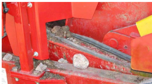
Rimuovere i sassi dal telaio - Lato sinistro
