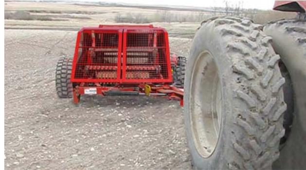
Zugarmposition 1 - Traktordoppelbereifung
