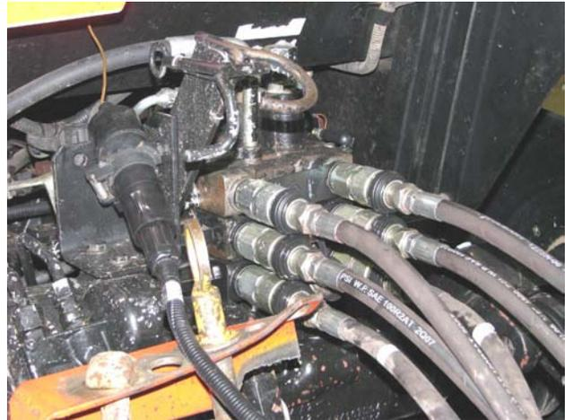
Verbindung der Hydraulikschläuche und Elektrik <sup>108008</sup>
