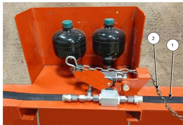
Schließen Sie die Abreißbremse am Traktor an (zur Verdeutlichung: der Schutz wird entfernt) <sup>217214C</sup>
