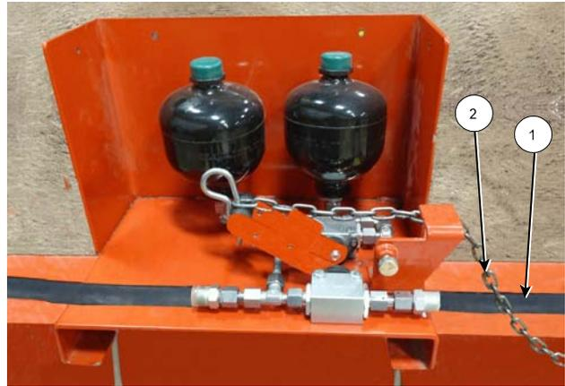
Trennen Sie die Abreißbremse vom Traktor (zur Verdeutlichung: der Schutz wird entfernt) 217214C
