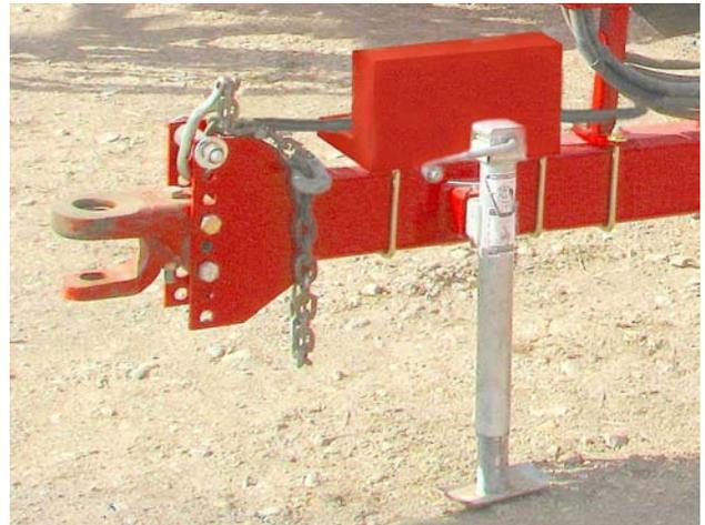
Heben sie den Zugarm mit dem Heber
