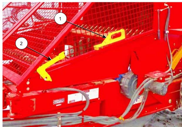
12. Entriegeln (2) sie den Rollenkäfig und heben sie diesen hoch.
