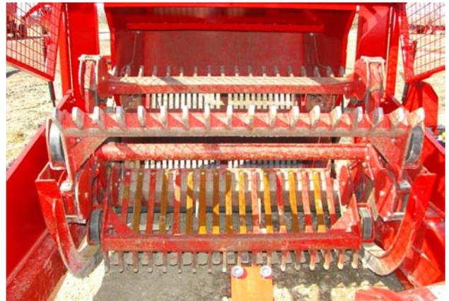
Prüfen sie den Zustand der Rolle, der Rampe und des Korbes. 216081
