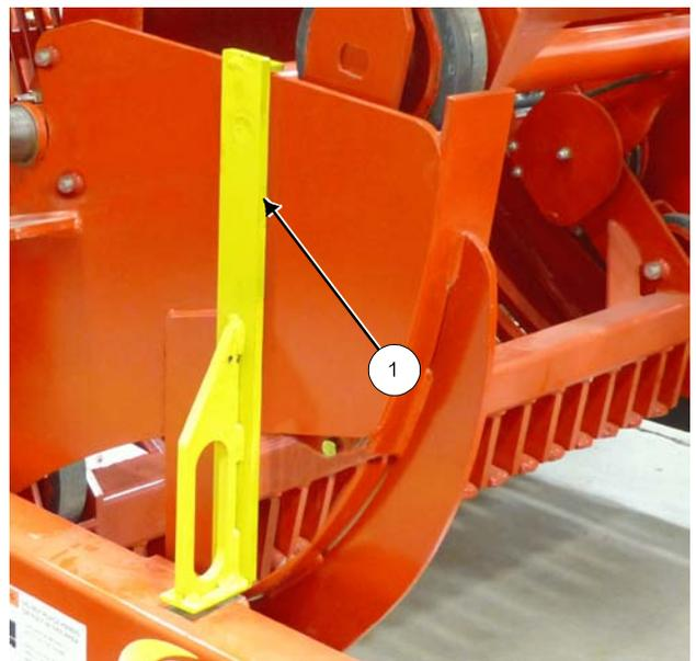
Die rechte Rampentransportsicherung entnehmen
