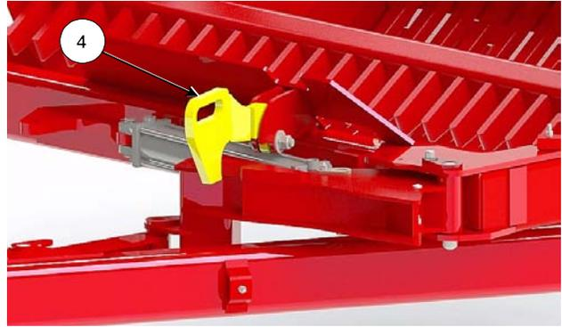
Rasten sie die Zugarmtransportsicherung ein 216240C
