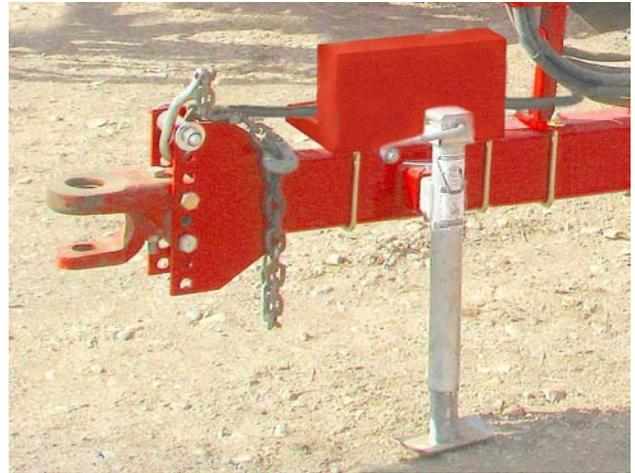
Heben sie den Zugarm mit dem Heber.
