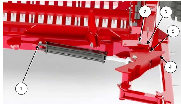
Ziehen sie die Bolzen (Position 1) heraus, um die Zugarmposition einzustellen.
