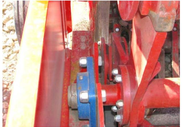
Schmieren sie beide Rollenkugellager (Rechts gezeigt)
