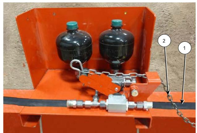
Schließen Sie die Abreißbremse am Traktor an (zur Verdeutlichung: der Schutz wird entfernt)
