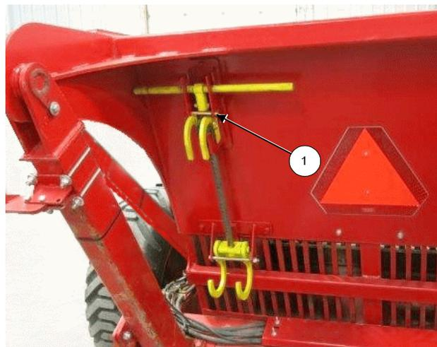
Spannwerkzeug in der Halterung
