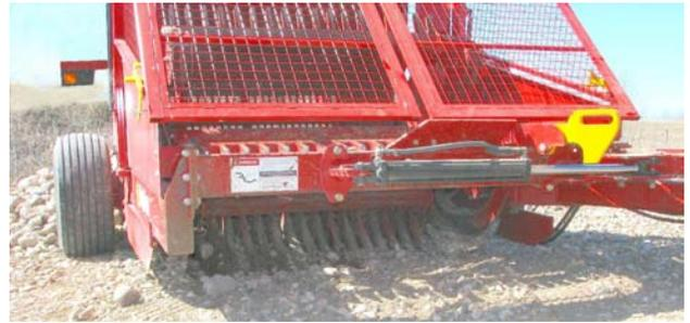
Zurückdrehen der Rolle & Rampe heben um Steine zu entfernen. 214011
