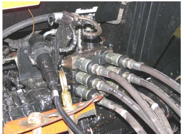
Trennen sie die Hydraulikschläuche und Elektrik<sup>108008</sup>
