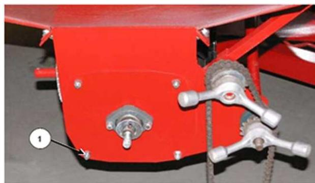
Выньте гайки из торцевой пластины
