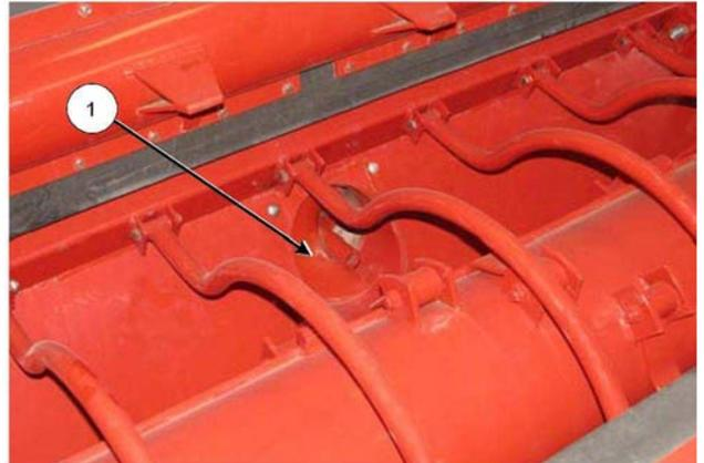
Проверьте выходное отверстие шнека 211180C
