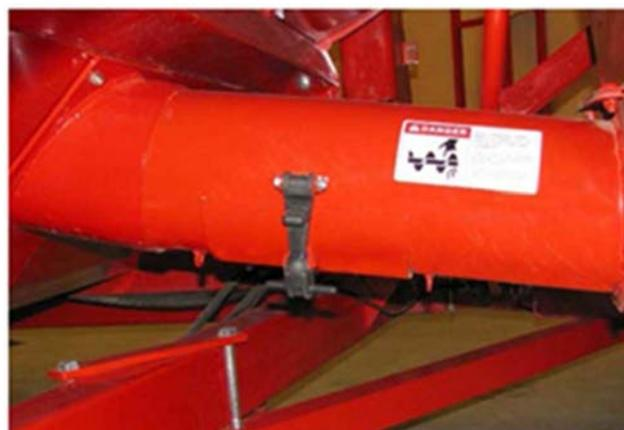
Закройте крышку калибровочного отверстия 211170
