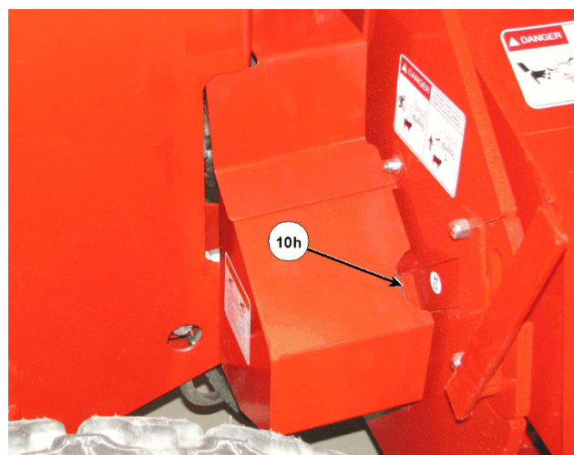
Смазка заднего подшипника ротора
