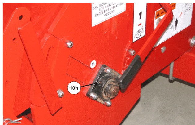
Смазка переднего подшипника ротора
