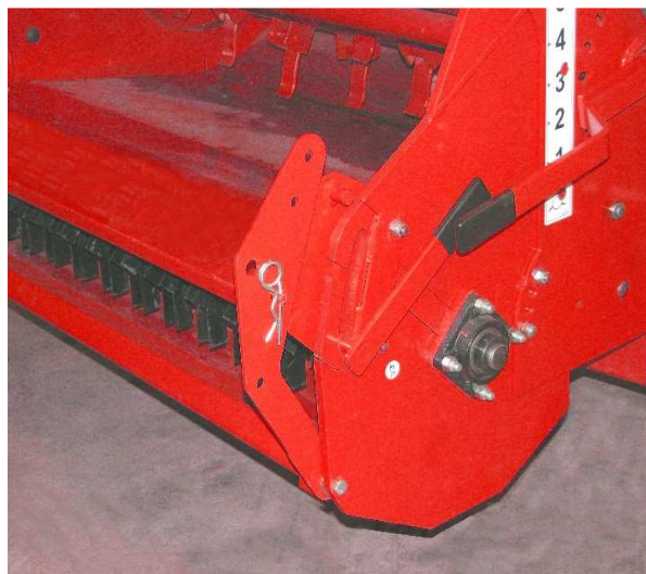
Опустите дверцу для выгрузки материала в измельчитель
