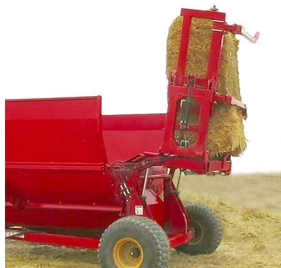
Отключите Лепестковой барабан перед загрузкой рулон 214100
