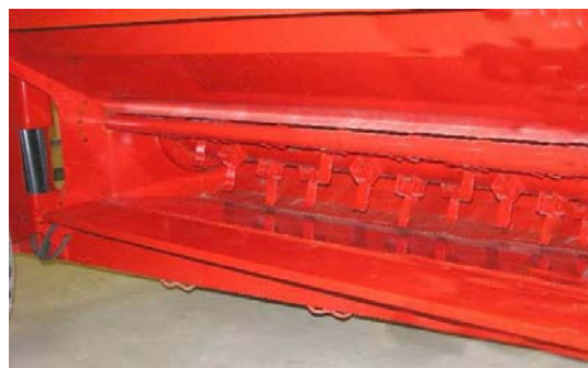
Устранение мусора в области Лепесткового барабана 214081
