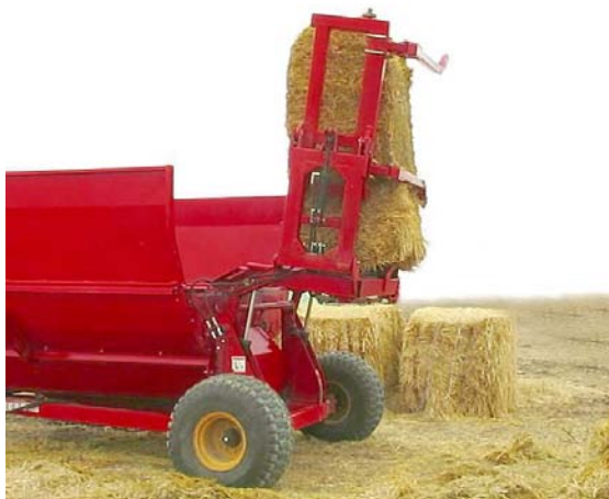
Загрузка тюка в бункер процессора. 214092
