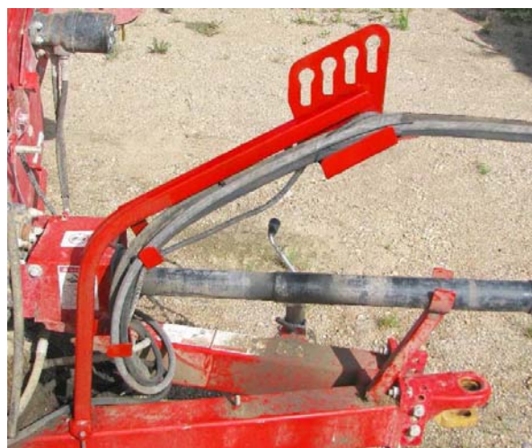
Шланги и кабель, проведенные через кронштейн
