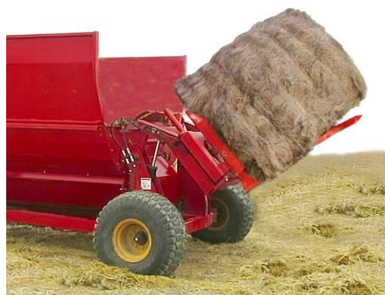
Загрузка тюка в бункер процессора. 214101
