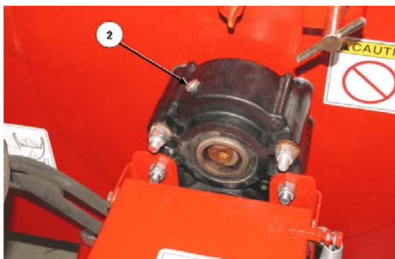
Добавление масла в редуктор 215168C
