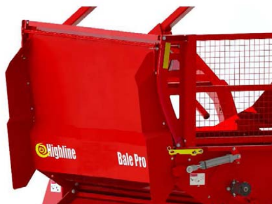
Поднятие двери дефлектора в транспортное положение. 215155-2
