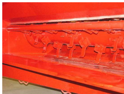
Проверка состояния Лепестков 214082
