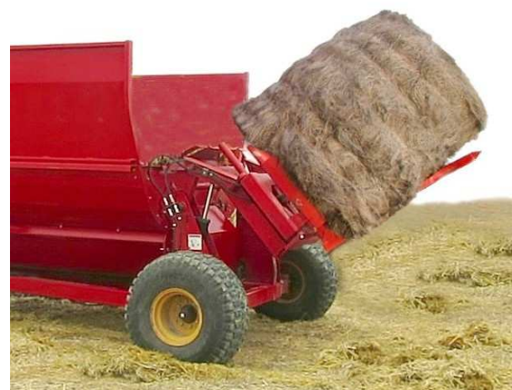
Отключите Лепестковой барабан перед загрузкой рулон 214101
