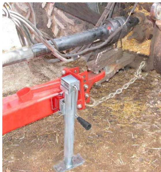
Поддомкратте фаркоп, отсоедините кардан и цепь. 214076
