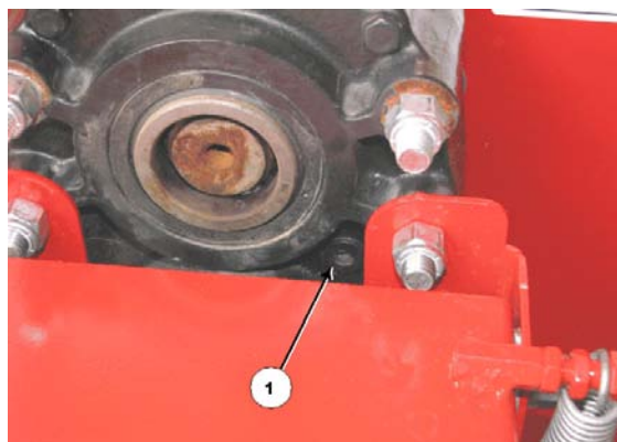
Проверка масла в редукторе
