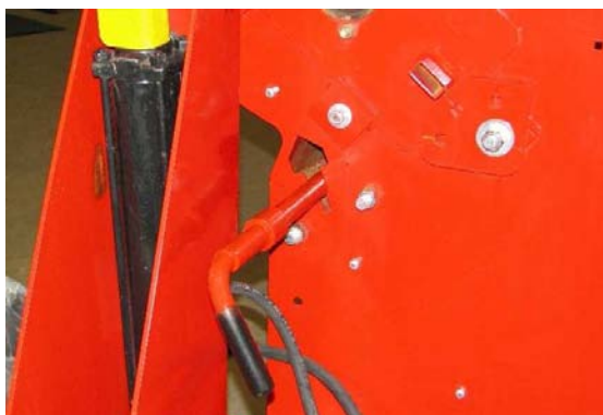
Установка механизма подрезания шпата в нерабочее положение 201231
