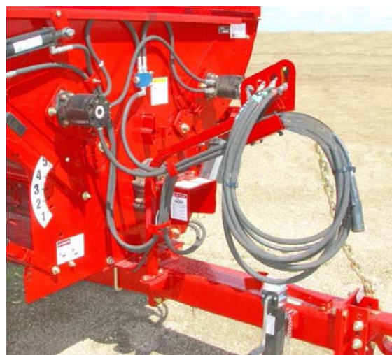
Отсоединение гидравлических шлангов и электрических проводов 216138
