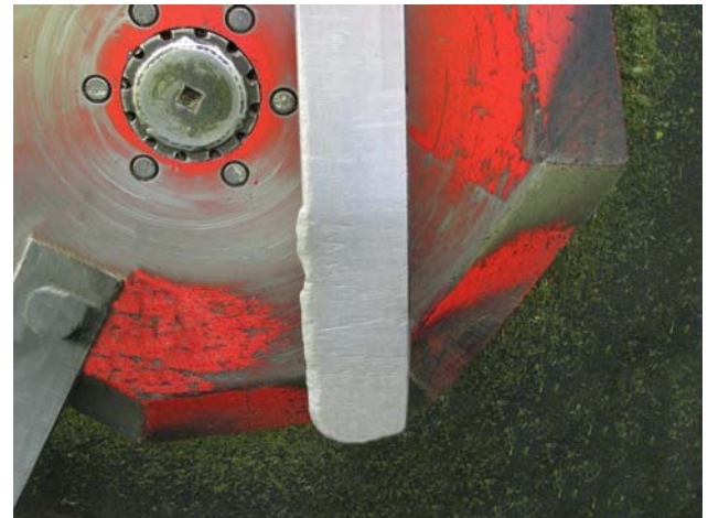
Replace Blade When Gouged 107080
