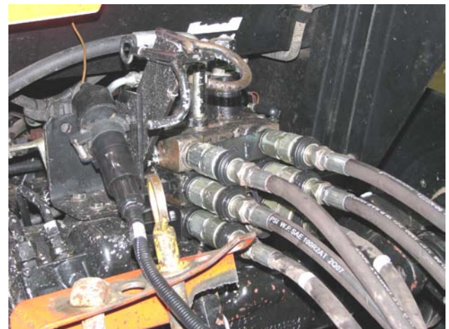
Débranchez les tuyaux hydrauliques et les câbles électriques
