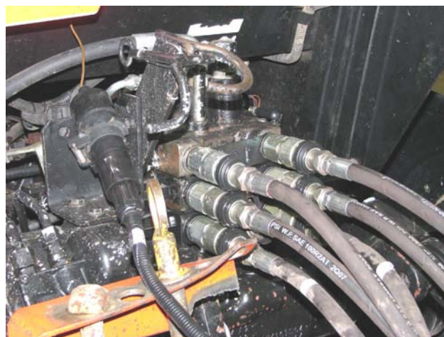
Débranchez les tuyaux hydrauliques
