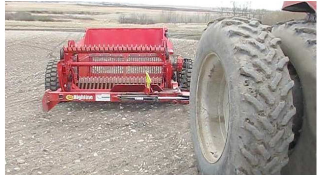
Position 1 de l'attelage : tracteur avec roues jumelées
