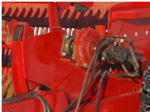
Graissez les roulements du rabatteur et remplacez l'huile de la boîte d'engrenages
