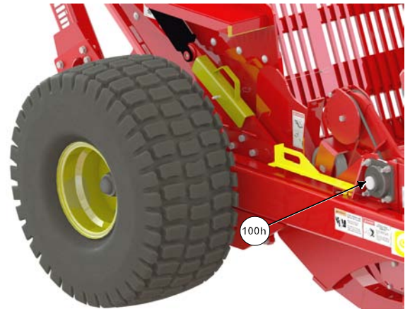
Graissez le roulement du rotor
