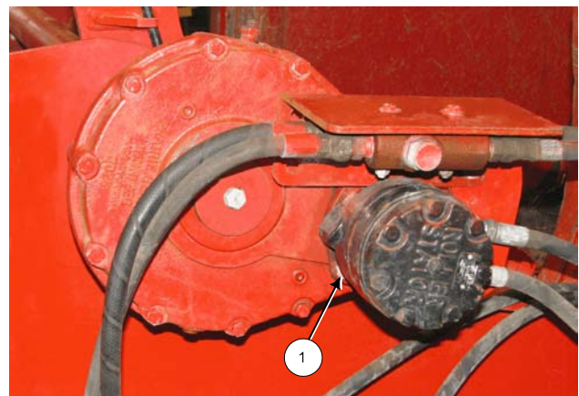
Vérifiez que les boulons de fixation du moteur sont bien serrés
