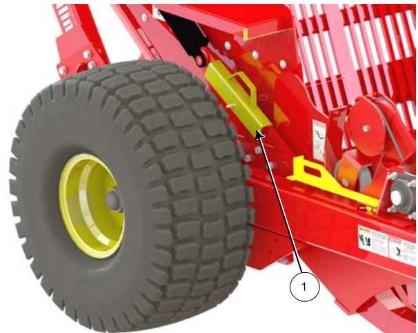
Verrou de la trémie en position désengagée
