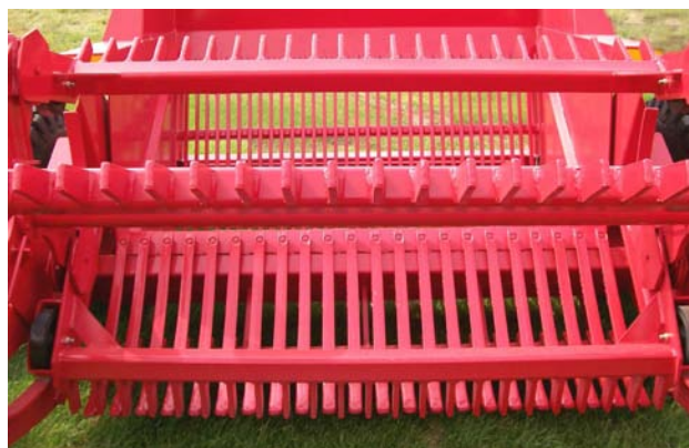
Vérifiez l'état du tablier et de la trémie
