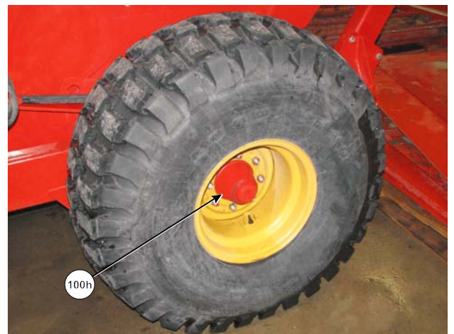
Graissez les moyeux des roues
