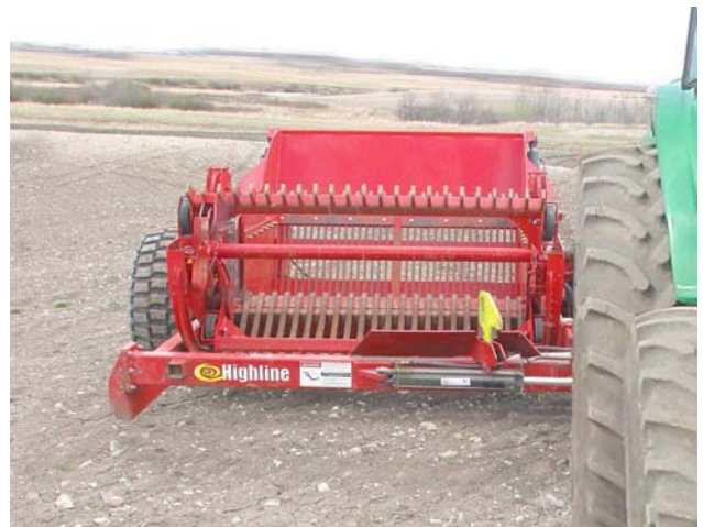
Position 2 de l'attelage : tracteur avec roues simples
