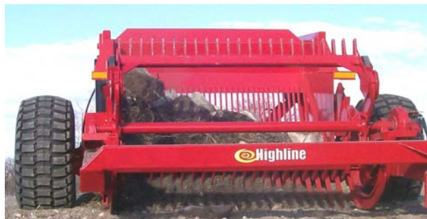
Inversez le rotor et relevez le tablier pour enlever les pierres
