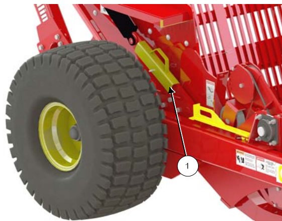
Verrou de la trémie en position désengagée
