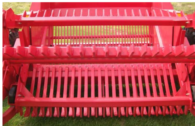
Serrez les boulons supérieurs et inférieurs des dents
