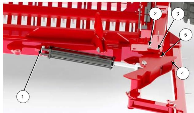
Configuration de la position 1 de l'attelage : tracteur avec roues jumelées
