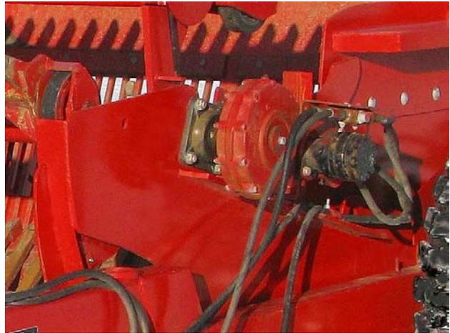
Graissez les roulements du rotor, changez l'huile de la boîte de vitesses 214025
