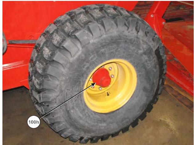
Graissez les moyeux des roues
