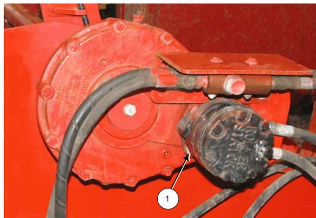
Vérifiez que les boulons de fixation du moteur sont bien serrés
