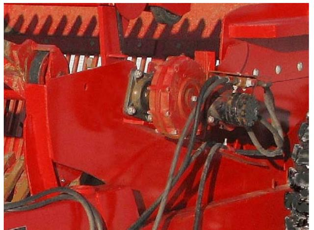
Graissez les roulements du rotor, changez l'huile de la boîte de vitesses
