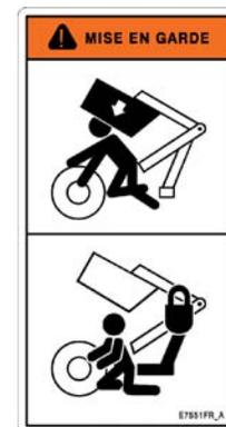
2. Insérez les verrous de levage de la trémie dans les tiges des vérins avant d'accéder en dessous de la trémie en position relevée.
