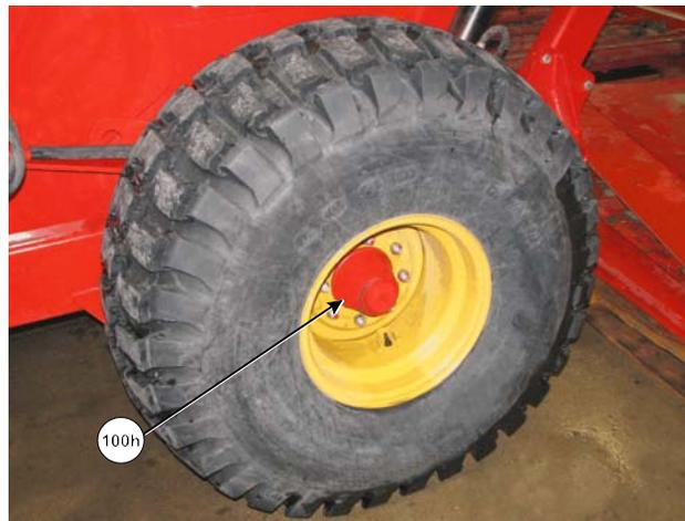
Graissez les moyeux des roues
