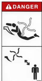
Les peignes de ramassage fonctionnent à l'aide de ressorts. Quand une pierre est coincée, les ressorts sont comprimés. Il existe alors un risque que les peignes se détendent brusquement, pouvant causer des blessures graves, voire mortelles.
