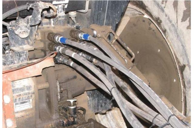
Débranchez les tuyaux hydrauliques et les câbles électriques
