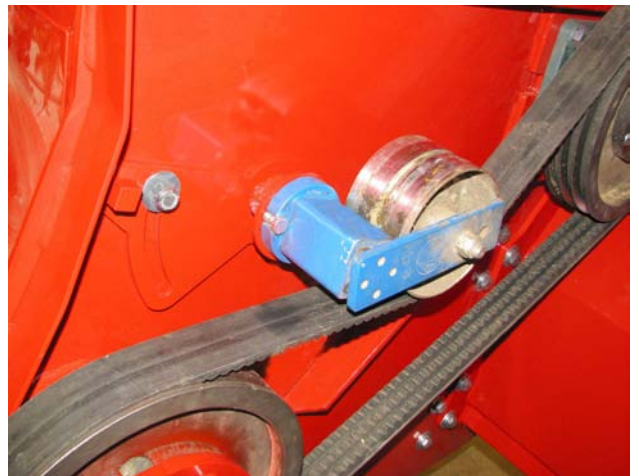
Проверка ремня привода и его натяжения
