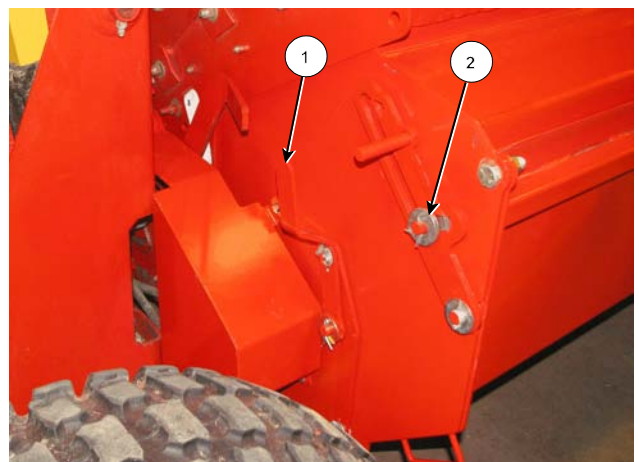
Закройте обе крышки кожуха шнека 212128C
