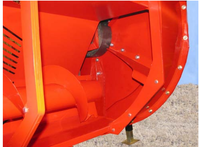
Устранение посторонних предметов из корпуса вентилятора 212127
