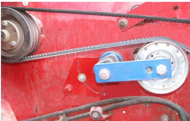
Проверка шнекового ремня и его натяжение
