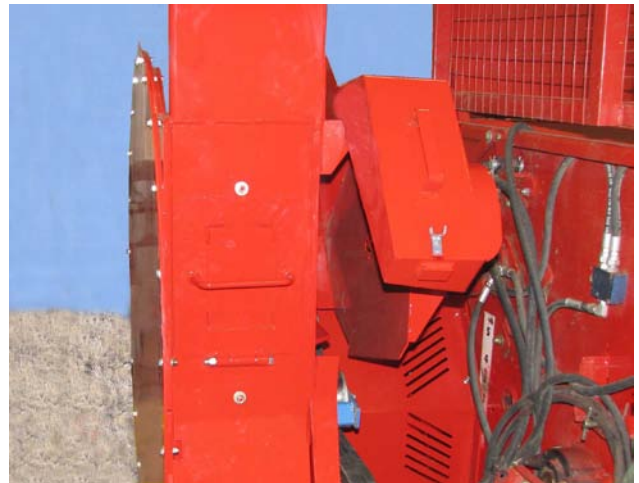
Поднятая защита привода – зафиксирована на опорной нише
