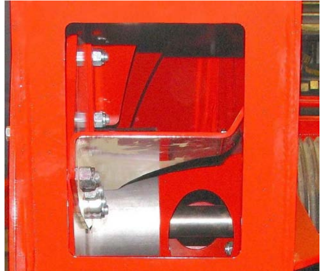
Используйте зеркало для проверки степени износа пластины вентилятора
