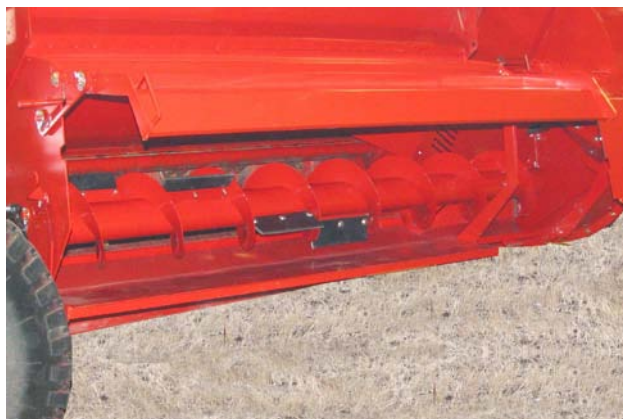
Проверьте состояния витков и лопастей
