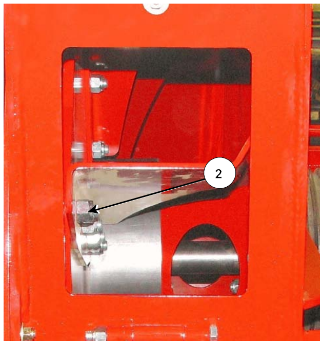
Выкрутка болтов / гаек для замены лопастей
