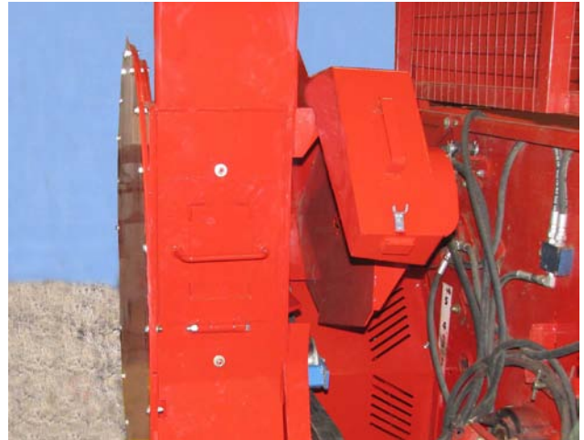
Поднимите защитный кожух привода вентилятора
