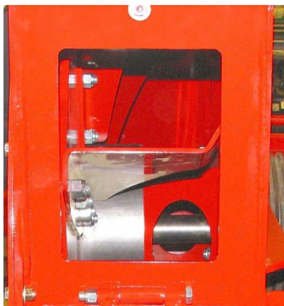
Осмотр лопастей вентилятора
