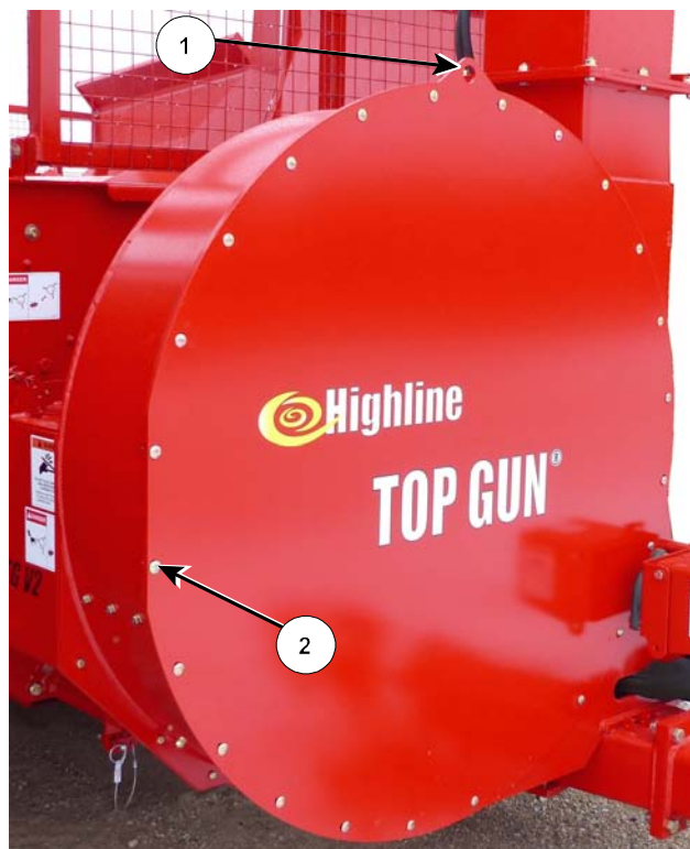
Отсоедините переднюю панель вентилятора 216220C
