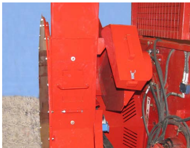
Поднимите защитный кожух привода вентилятора
