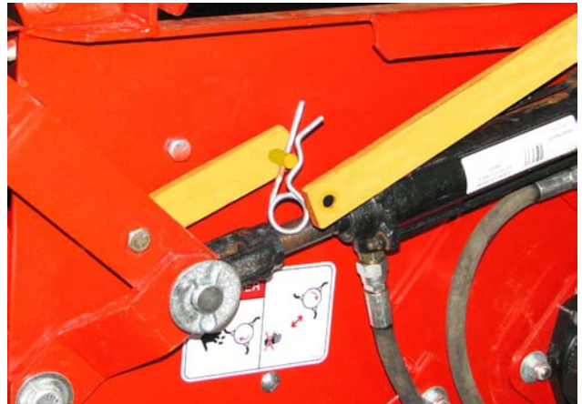
Снятие стопорного штифта с дверцы дефлектора
