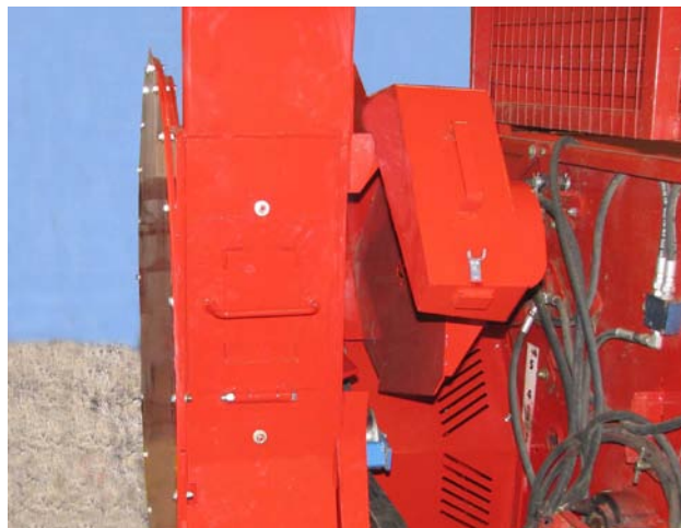
Поднимите защитный кожух привода вентилятора
