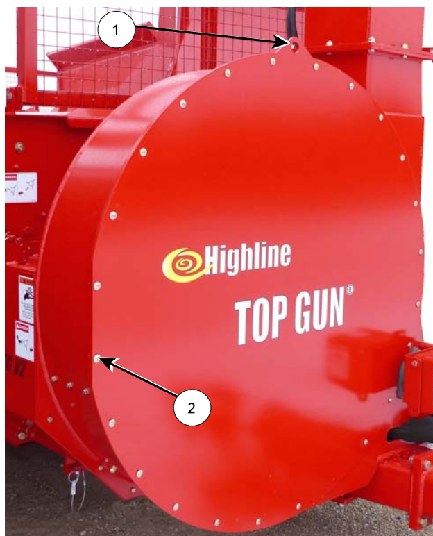
Отсоедините переднюю панель вентилятора 216220C
