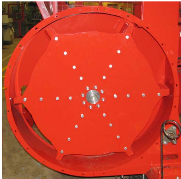
Отсоедините переднюю панель вентилятора 216066
