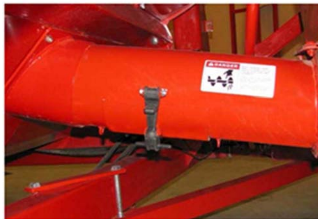
Закройте крышку калибровочного отверстия 211170
