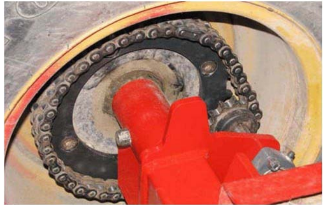
Смажьте приводную цепь колеса
