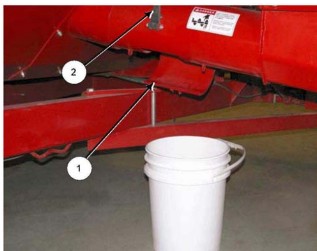
Очистка кожуха и камеры шнека
