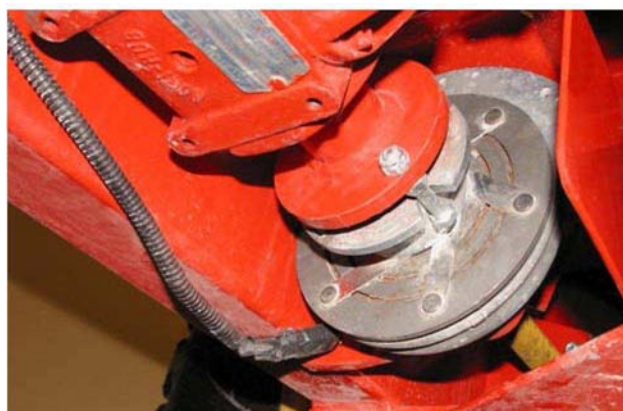
Очистите электрическую муфту от мусора
