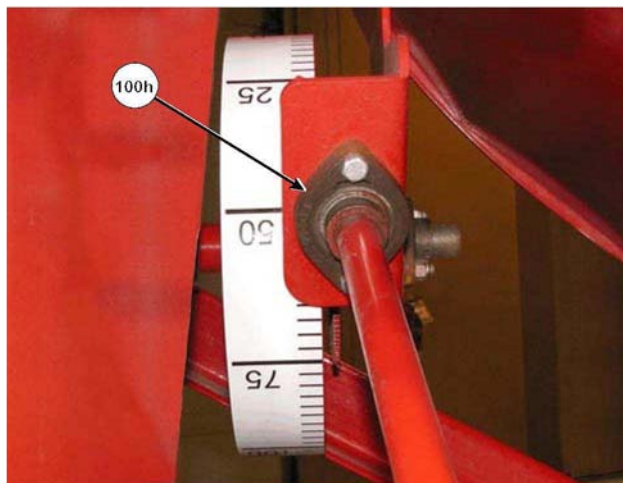
Смазывайте задние подшипники счетчика длины пути
