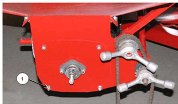
Выньте гайки из торцевой пластины
