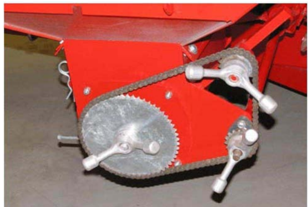
Смажьте приводную цепь шнека
