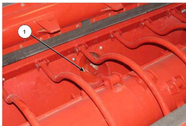
Проверьте выходное отверстие шнека 211180C
