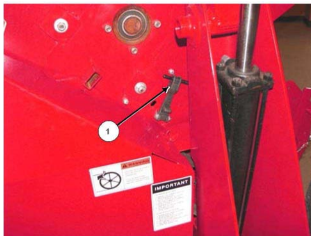
Снимите резиновый запор дверцы
