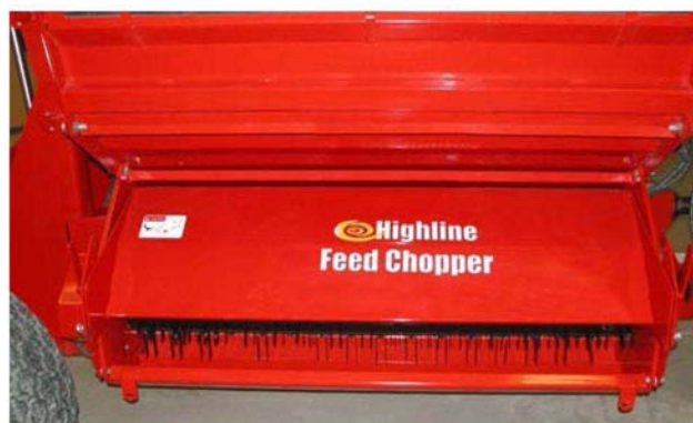
Проверьте состояние ножей
