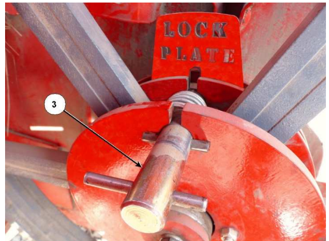
Штырь привода в свободном положении
