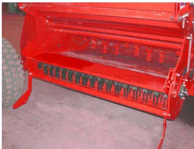
Отсоедините держатели разгрузочной дверцы 201238
