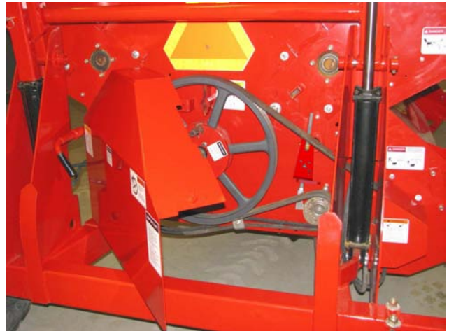
Проверка натяжения приводного ремня
