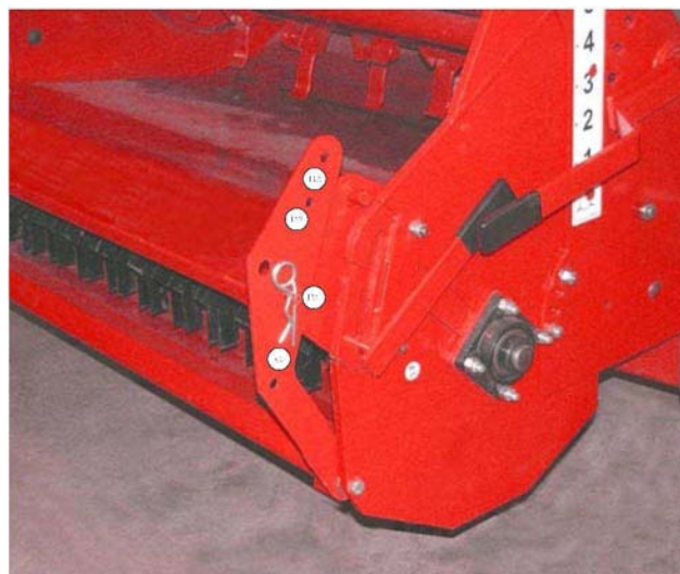
Опустите дверцу для выгрузки материала в измельчитель
