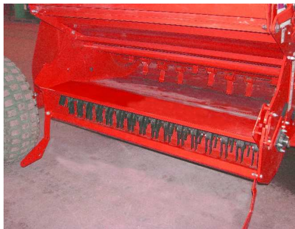
Отсоедините держатели разгрузочной дверцы 201238
