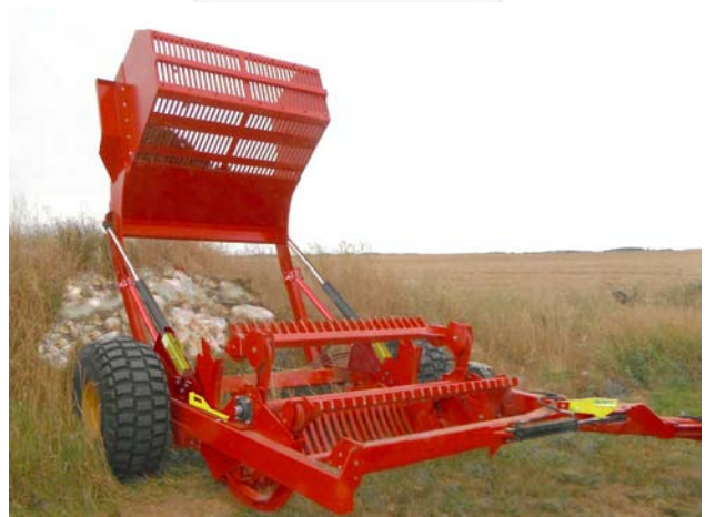
Ковш в позиции сбрасывания камней
