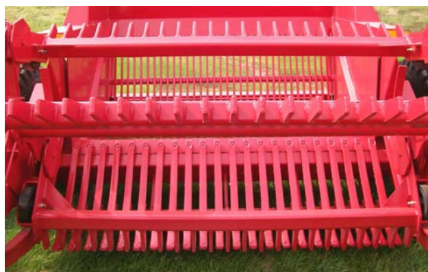
Проверьте состояние мотовила, фартука и ковша
