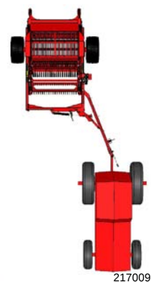
Положение прицепного устройства 1 - Сдвоенные тракторные колеса
