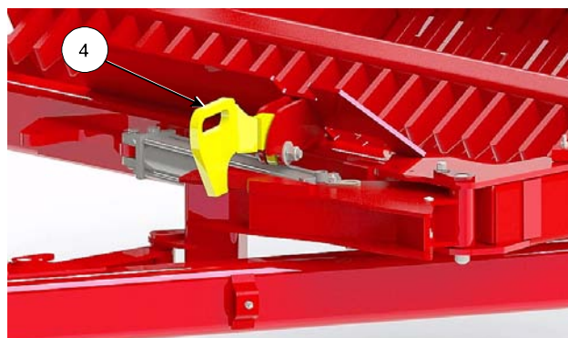
Зафиксируйте транспортный замок прицепного устройства
