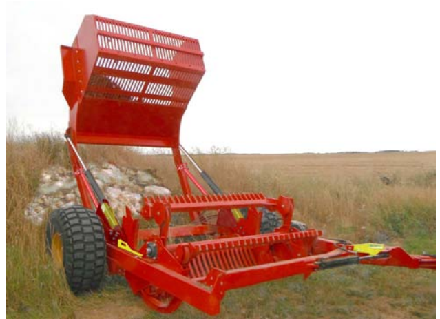
Ковш в позиции для сбрасывания камней
