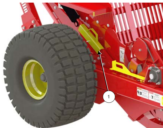
Блокировочные замки ковша в позиции хранения
