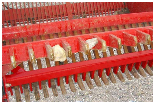
Уберите камни, застрявшие между зубьев.
