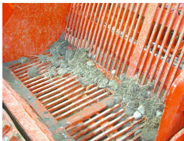
Очистите ковш от мусора
