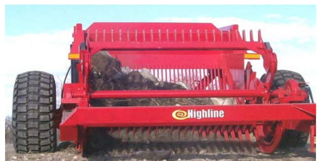
Задний ход мотовила и подъем фартука для удаления камней
