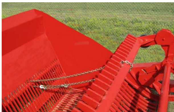
Зачалить гребенку ротора к решетке бункера
