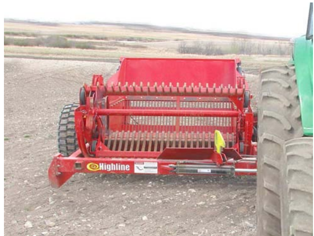
Позиция прицепного устройства 2 - для работы с трактором с одинарными колесами 215247
