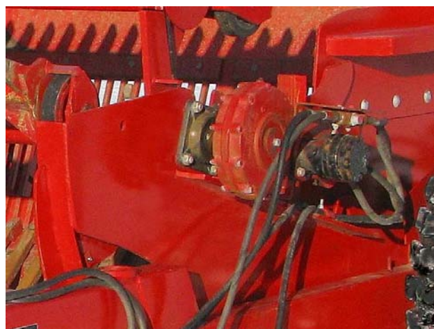
Смазывание правого и левого подшипников мотовила 214025
