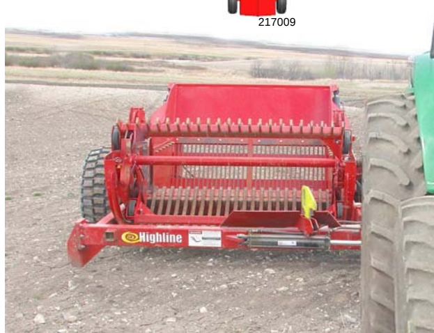
Положение 2 - для работы с трактором с одинарными колесами
