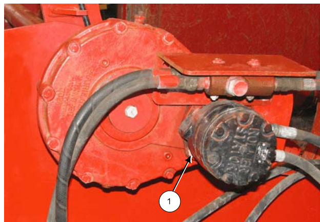
Проверка болтов крепления мотора
