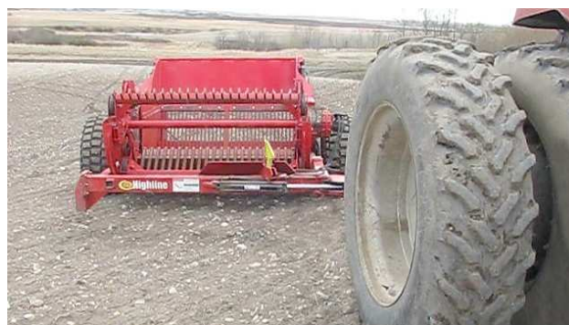
Рабочее положение камнеподборщика
