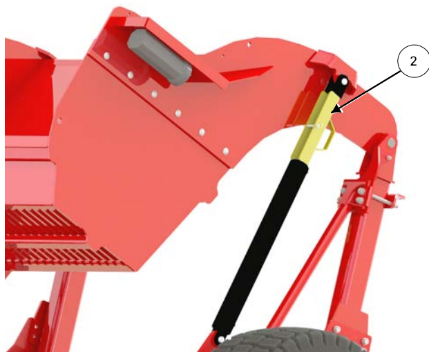
Блокировочный замок на цилиндре ковша
