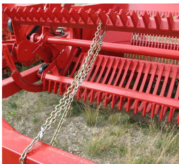
Зачалить цепью ближайшую незащемленную гребенку ротора
