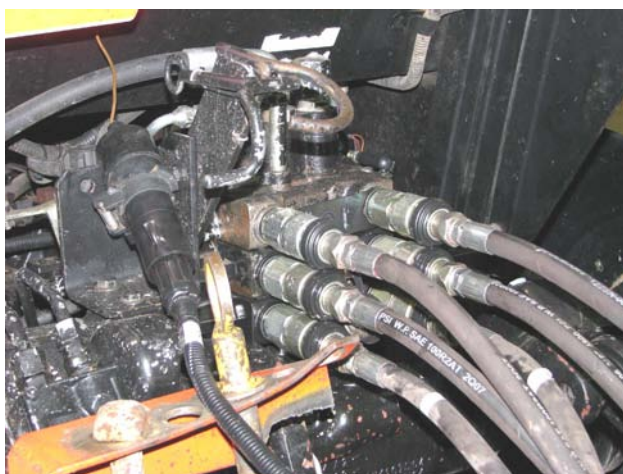
Отсоедините гидравлические шланги и электрические соединения.
