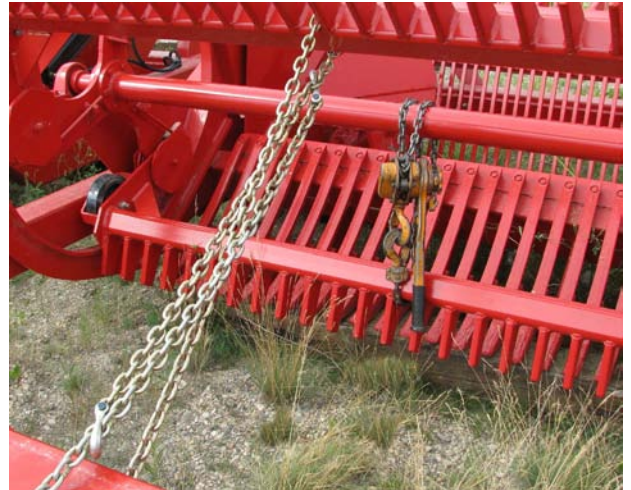
подтянуть гребенку против действия пружин 108193
