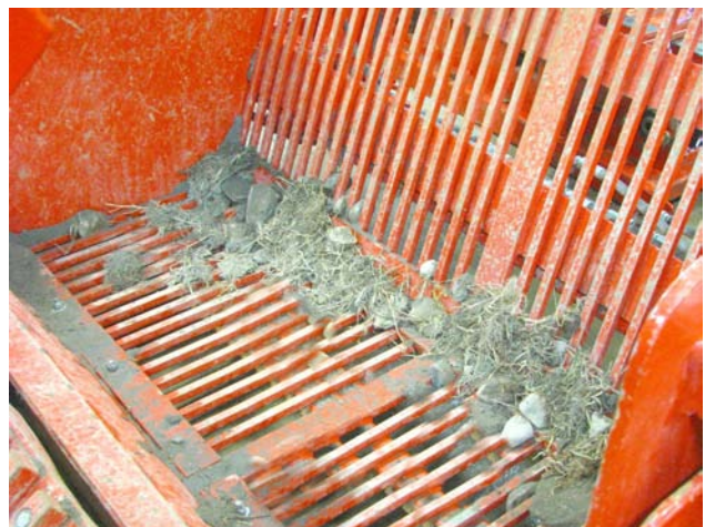
Очистка агрегата от мусора и камней
