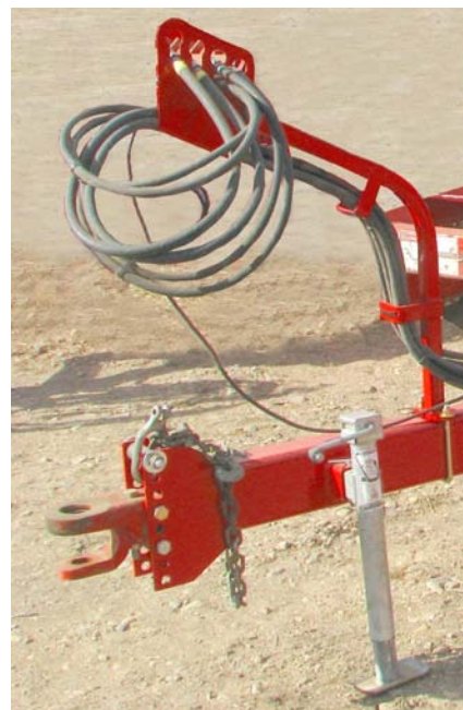
Отсоедините страховочную цепь и прицепное устройство 216233-1
